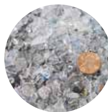
Flocons de polyéthylène téréphtalate (PET) avec aluminium (4 à 10 mm) 96 % de la contamination par l'aluminium éliminée
