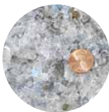
Flocons de polyéthylène téréphtalate (PET) avec aluminium (< 4 mm) 93 % de la contamination par l'aluminium éliminée
