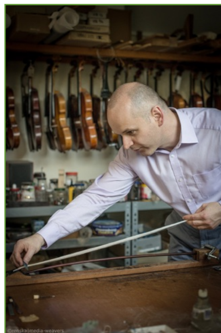
Jelle Boomsma (Den Haag) werkend aan het opnieuw beharen van een strijkstok
