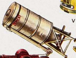
V 155 Silo-Transportwagen Höschle-Spezial-Transportaufbau; Silo kann abgenommen und gefüllt werden.
