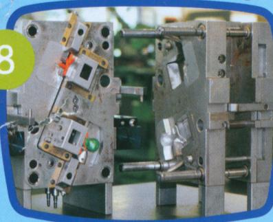
... nach der später die Spritzgussformen aus Metall für die Drachenteile gebaut werden. Hier siehst du die Form für die Drachenfüße.
