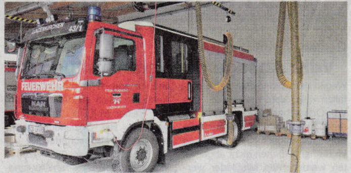
Das neue Löschfahrzeug, angeschlossen an die Abgasabsauganlage und das Ladeerhaltungssystem mit Druckluftversorgung an einem Stecker.
