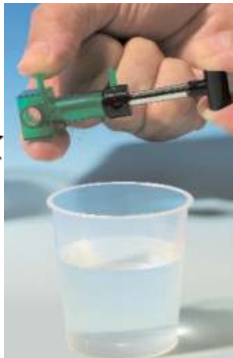
O ar pode ser comprimido mas a água não (ou pelo menos, quase nada)
