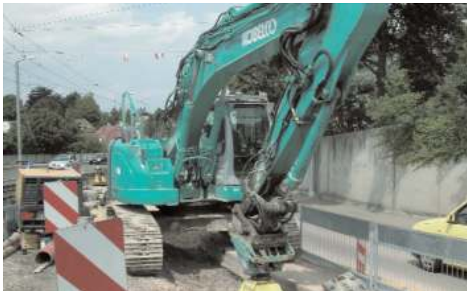
As escavadoras funcionam com base nos princípios hidráulicos.
