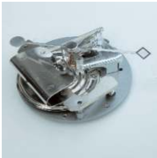
Um barómetro aneróide com o seu delicado mecanismo de transferência.
