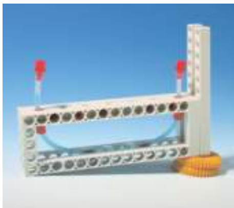
Como medir o desnível numa superfície inclinada
