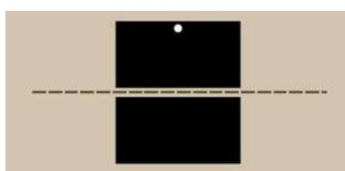
AS LATERAIS E O FUNDO DO TRIUNFO PLUS SÃO DO TIPO BIPARTIDOS. ISSO POSSIBILITA RETIRAR APENAS UMA PARTE SUPERIOR PARA MANUTENÇÃO, SE NECESSÁRIO. OUTRA VANTAGEM É QUE, CASO UMA LATERAL SEJA DANIFICADA EM UM ACIDENTE, APENAS METADE DELA PODE SER SUBSTITUÍDA, EM VEZ DE TODA A LATERAL.
