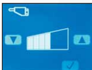
Regolazione di precisione della portata idraulica in modalità B (martello).
