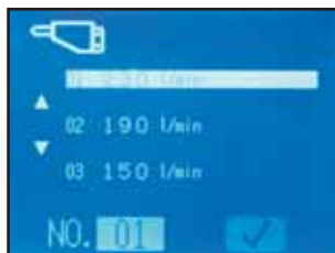
Regolazione della portata idraulica in modalità B (martello).
