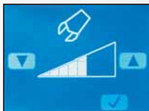
Regolazione della portata idraulica degli accessori in modalità P (Power) o E (Economy).
