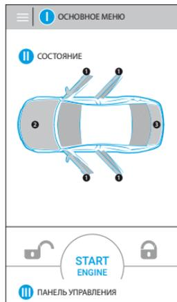
**II ПАНЕЛЬ УПРАВЛЕНИЯ** - предназначена для управления режимами и функциями системы с помощью кнопок управления. Включение и выключение функций и режимов производится при помощи удержания кнопки до полной загрузки шкалы (защита от случайного нажатия).
