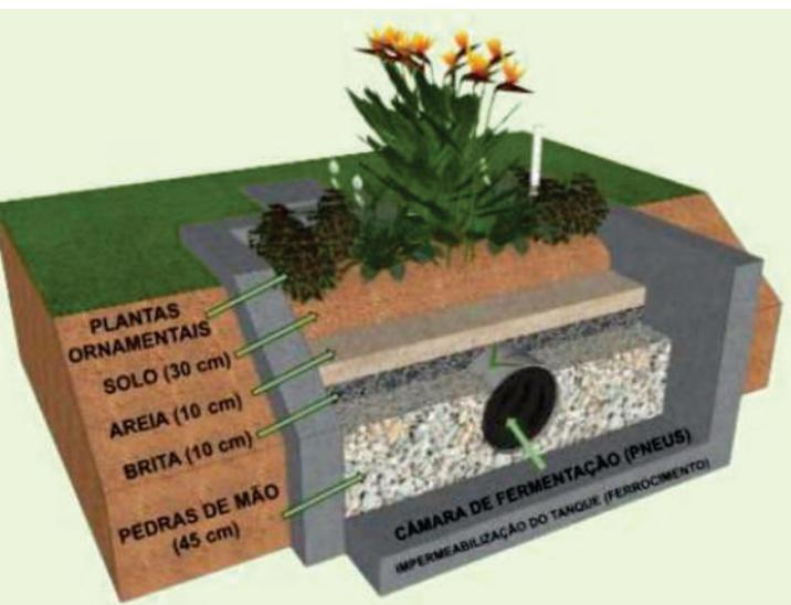
Corte esquemático Tevap - Fonte: Emater/MG
