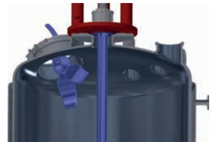
② 2: Die Form der Turbine erlaubt das Einbringen des Rührorgans durch die Mannlochöffnung The shape of the turbine allows for assembly through the manhole-opening
