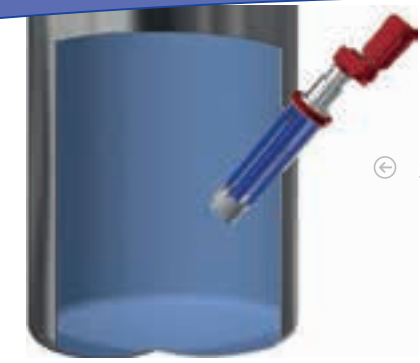
2: Temperatursensor, eingebaut in eines der emaillierten Stützrohre Temperature Sensor, installed in one of the glass lined supports
