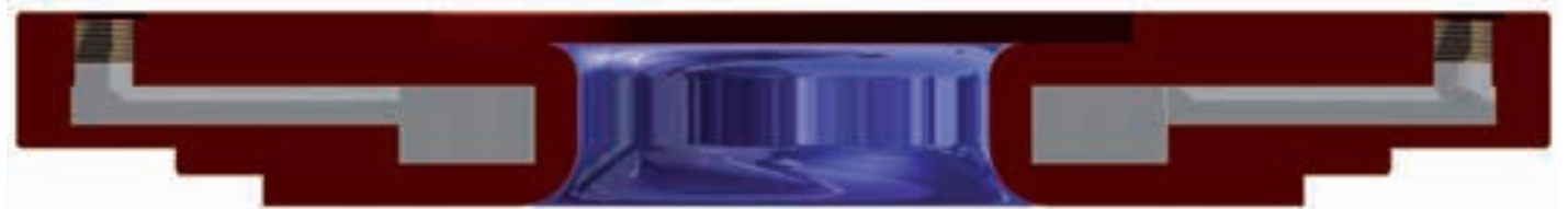
3: Schnitt durch den THALETEC THERMO-Grundflansch für Gleitringdichtungen / Section through the THALETEC THERMO base flange for mechanical seals
