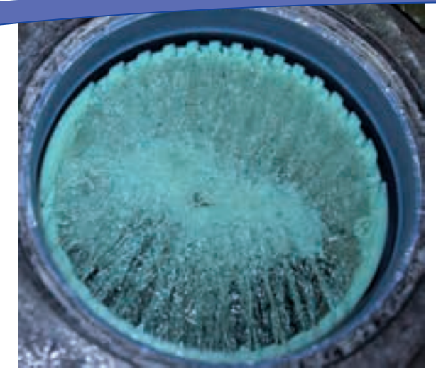
Spülmuster des THALETEC ClearView klare Sicht nach wenigen Sekunden Spray pattern. Clear view in few seconds
