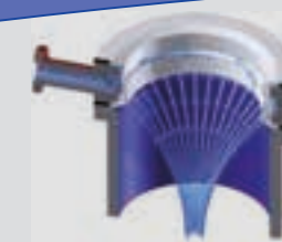
2: Schnittansicht Strömungsbild durch PTFE-Düsenring / Sectional view flow pattern by nozzle ring
