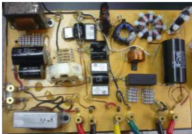
Fig. 27 - Il layout del nuovo circuito crossover delle La Scala – La componentistica impiegata per questo circuito rappresenta il nostro standard più elevato denominato “ Ultra Grade ”: paralleli di resistenze ad impasto di carbone da 2 Watt al 5%, selezione di paralleli di condensatori in polipropilene metallizzato con tolleranze nominali al 2% - 600 Vdc ed induttanze avvolte a mano. Se elettricamente è tutto ok, avessimo avuto un po' più di tempo, anche il layout del circuito poteva venire un po' più perfettino-precisino... Secondo voi, può bastare così? Noi rispondiamo ... mhh ...
