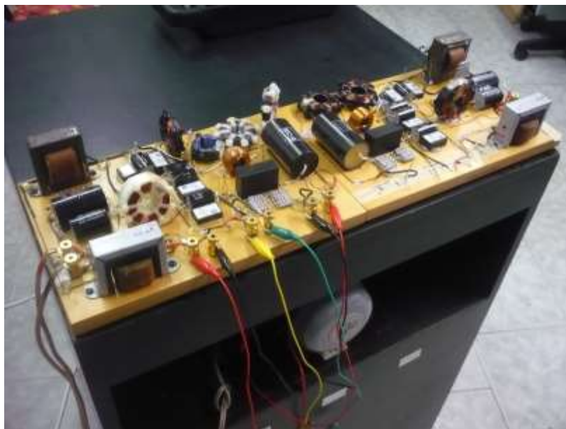
Fig. 31 - Specularità dei circuiti. Un piccolo grattacapo in più per lo sbroglio del layout ... Da sx verso dx: morsetti woofer, midrange, tweeter. Sull'altro circuito, rigorosamente tweeter, midrange, woofer ... ovviamente invertendo anche l'ordine delle polarità. Si veda a dx il positivo del ramo del woofer del circuito in costruzione, in totale opposizione con il primo crossover a sx
