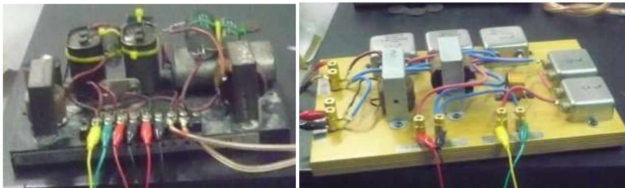
Fig. 01 - Rilevazione delle misure elettroacustiche effettuate con le due tipologie di crossover che ci sono stati consegnati (a sx quello originale Klipsch, il “Type AA” interessato da un recente recapping dal precedente proprietario – a dx quello artigianale “Type AA replica”)
