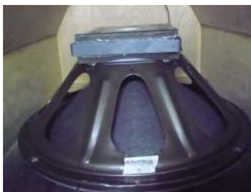
Fig. 07 - Abbiamo comunque ruotato di 180° ambo i woofer per compensare un eventuale rilassamento dello spider (centratore) e della sospensione, potenziali rilassamenti causati dall'azione delle forze di gravità (la membrana di un 15" ha una discreta forza-peso ...) e garantire nel contempo la corretta posizione in tolleranza della bobina all'interno del traferro; con il passare degli anni questo fenomeno può a volte accadere. Ricordiamo che questi diffusori hanno più di 40 anni di musica sulle spalle, riprodotta in chissà quali condizioni.
