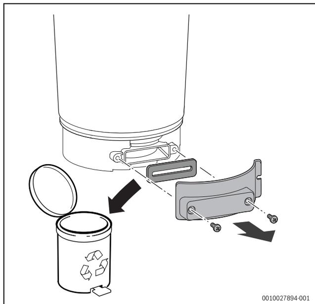
Fig. 64 Apertura dell'apertura di ispezione
