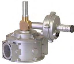
Le valvole di blocco di massima hanno la funzione di bloccare a monte il flusso del gas mettendo l'intero sistema in sicurezza. La chiusura da parte della valvola avviene in modo automatico quando il valore della pressione di regolazione supera per cause accidentali, la pressione di taratura del blocco. L'apertura della valvola può avvenire solo manualmente e deve avvenire solo dopo aver accertato ed eliminato l'inconveniente che ha provocato la chiusura.
