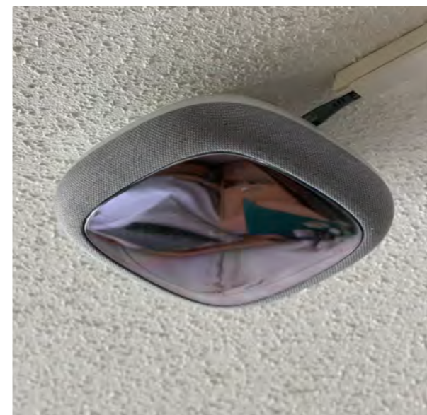
Mobile Sturzsensoren an der Zimmerdecke © Korian Stiftung für Pflege und würdevolles Altern
