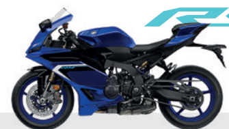
Brembo-Hauptzylinder vorne und Stylema-Brems-sättel gepaart mit 320 mm Bremsschreiben.
