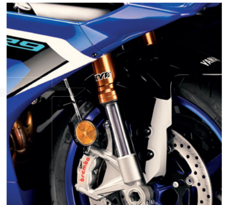
Brembo-Hauptzylinder vorne und Stylema-Brems-sättel gepaart mit 320 mm Bremsschreiben.
