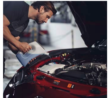
Wir kontrollieren auch, ob genügend Frostschutzmittel im Kühlsystem vorhanden ist.
