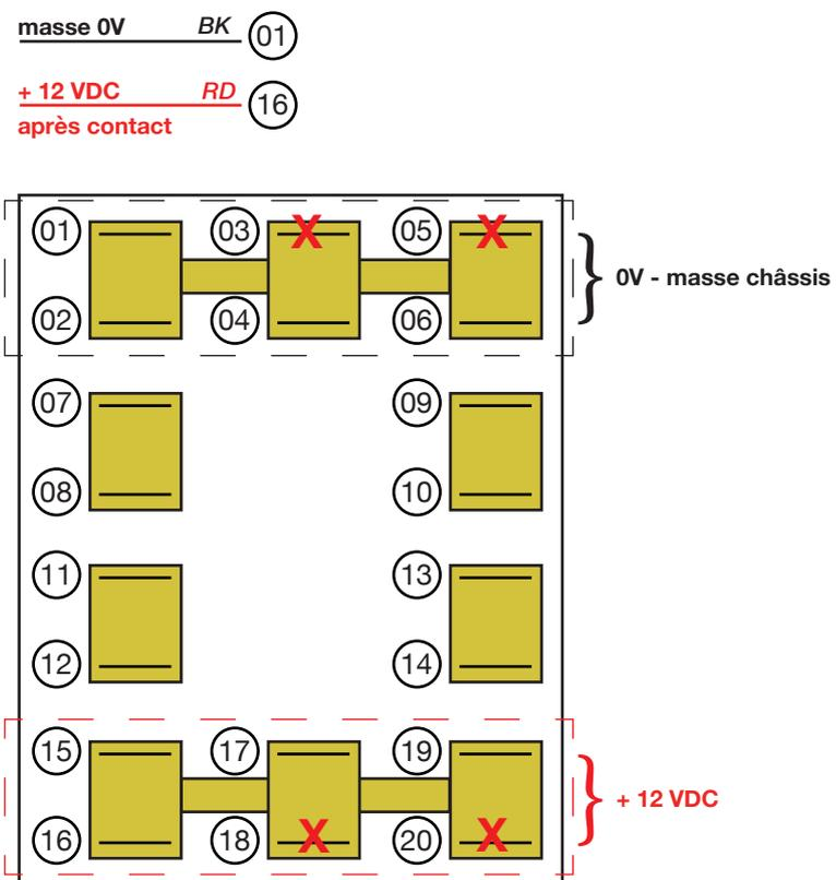
Platine de raccordement vue du côté des cosses
