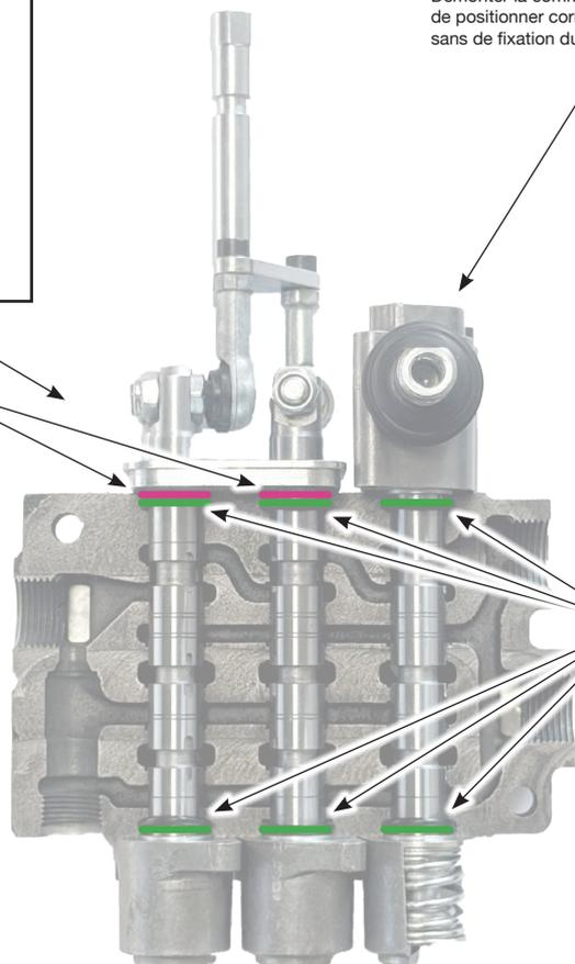
Vue écorchée d'un distributeur hydraulique
