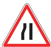
Figura 18 strettoia a sinistra
