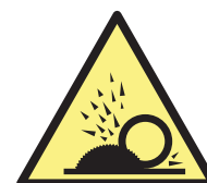
Pericolo proiezioni di schegge
