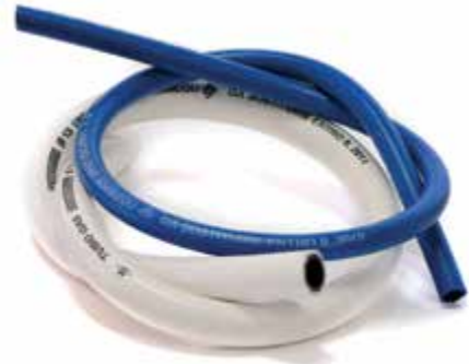
Tubo flessibile in formulazione speciale di gomma termoplastica con maglia di rinforzo in fibra poliestere ad alta tenacità. In PVC per mandata GPL e Metano per uso domestico.
