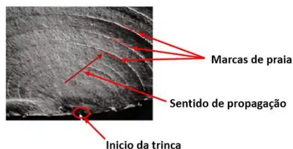
Figura 2 – Falha por Fadiga. Fonte: Inspeção de Equipamentos (2014).
