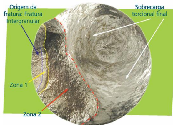
Figura 9 – Etapas do desenvolvimento de uma trinca até o rompimento.
