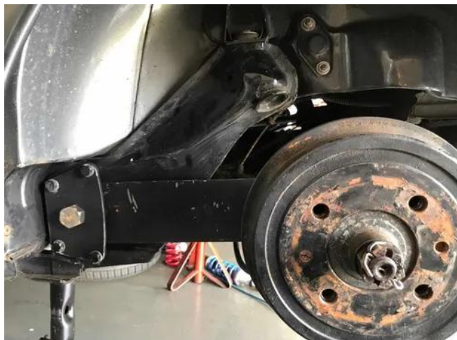
Figura 1 – Exemplo de junta aparafusada aplicada em veículos leves.
