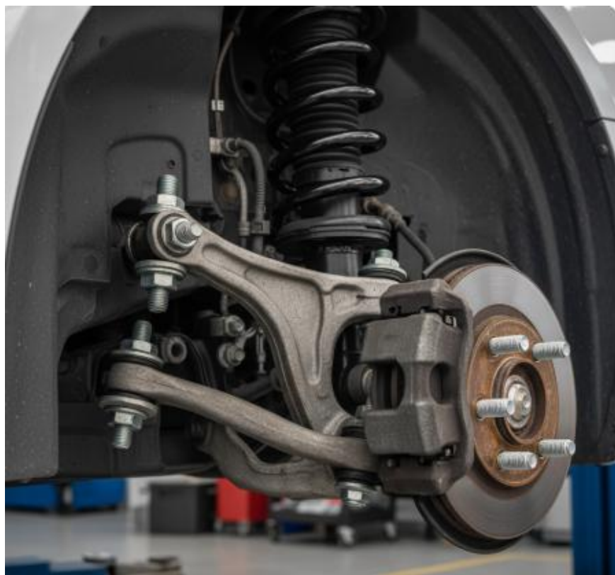
Figura 3 – Aplicações de parafusos em suspensão de automóveis.
