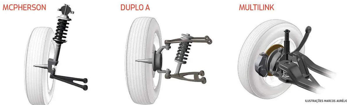
Figura 2: Braços de suspensão Mcpherson, duplo A e multilink.
