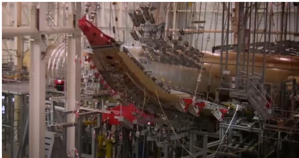
Figura 6 – Teste de resistência em uma asa de avião, feito pela Airbus.
