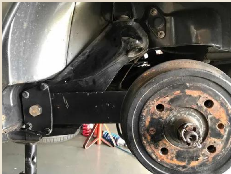
Exemplo de junta aparafusada em veículos leves.
