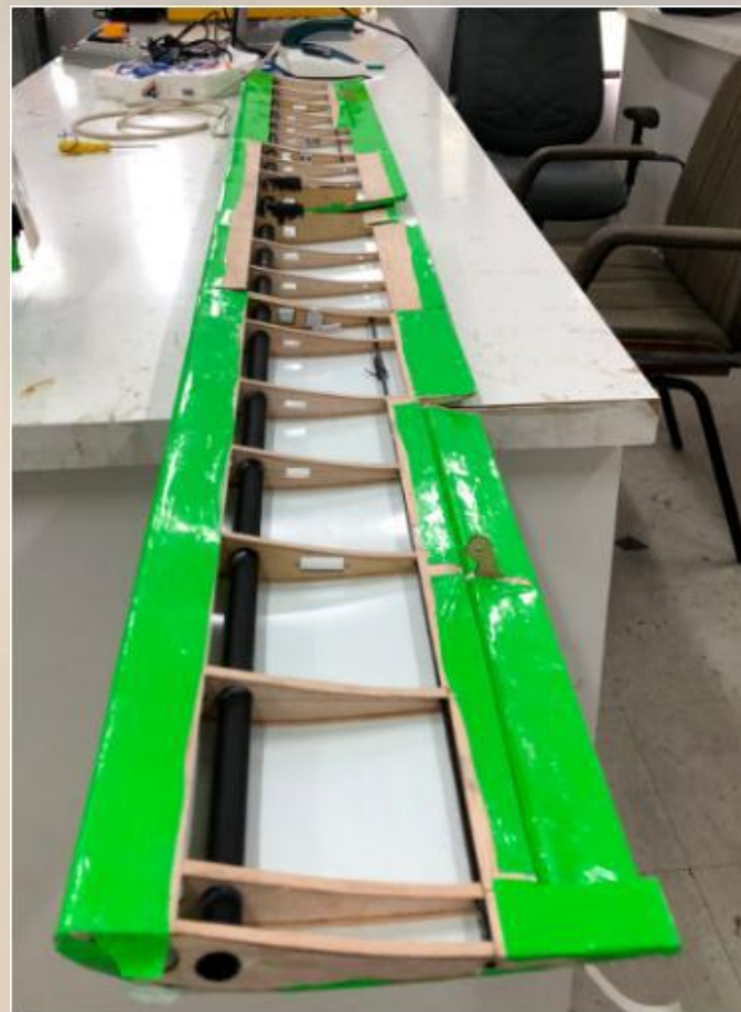
Figura 3 – Visão do extradorso e intradorso da asa com o acelerômetro instalado - Fonte: Raimundo (2025).
