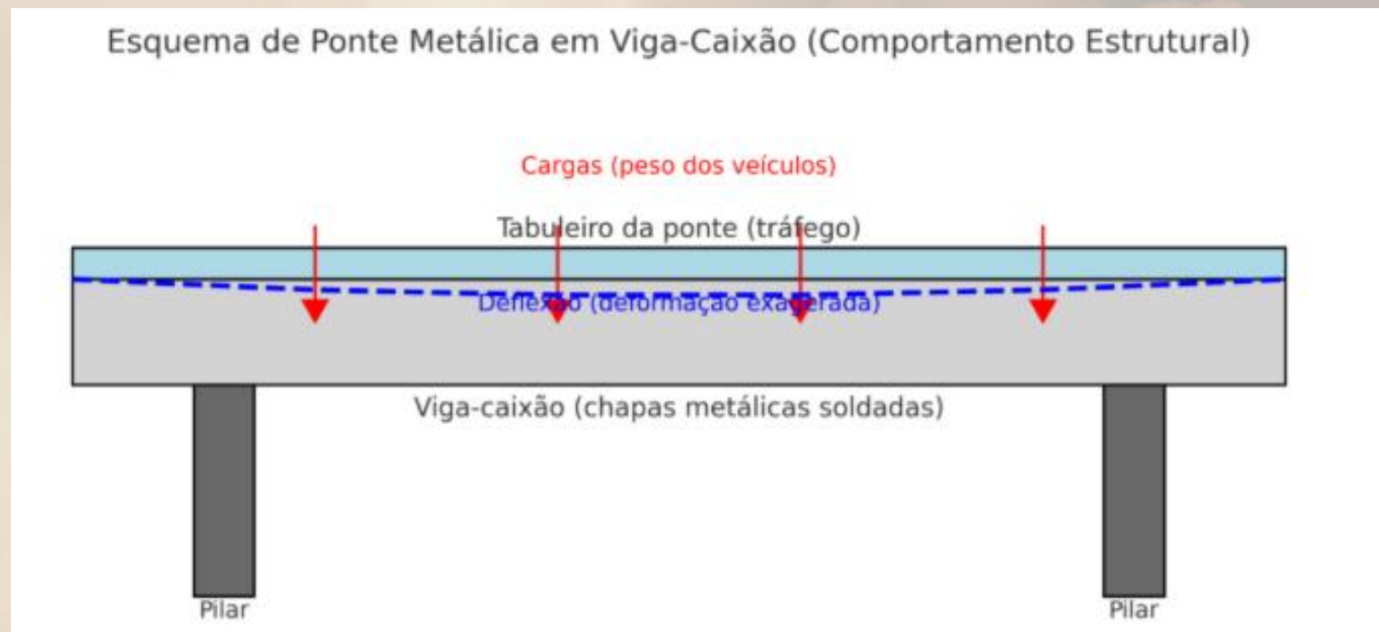
Esquema de Ponte Metálica em Viga-Caixaõ.
