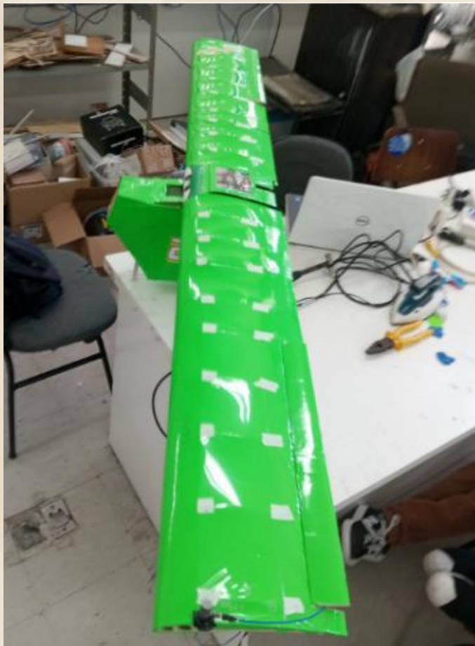
Figura 3 – Visão do extradorso e intradorso da asa com o acelerômetro instalado - Fonte: Raimundo (2025).
