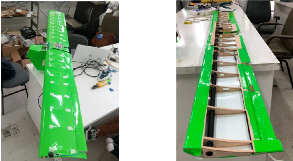
Figura 3 – Visão do extradorso e intradorso da asa com o acelerômetro instalado Fonte: Raimundo (2025).
