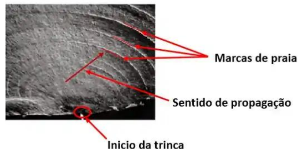
Figura 2 – Falha por Fadiga. Fonte: Inspeção de Equipamentos (2014) .
