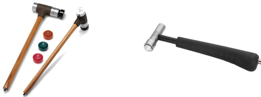
Figura 2 – Marreta modal (Médias e Grandes Estruturas) e Martelo de impacto - (Médias e Pequenas estruturas), Fonte: Brüel & Kjær (2025).
