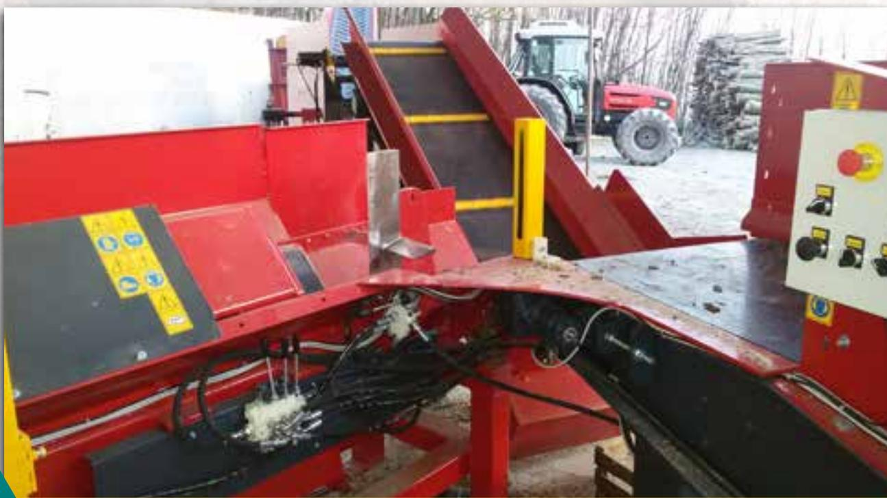
Postazione di spacco con spaccalegna orizzontale aperta per il ripasso del materiale, con barriere fotoelettriche di sicurezza.
