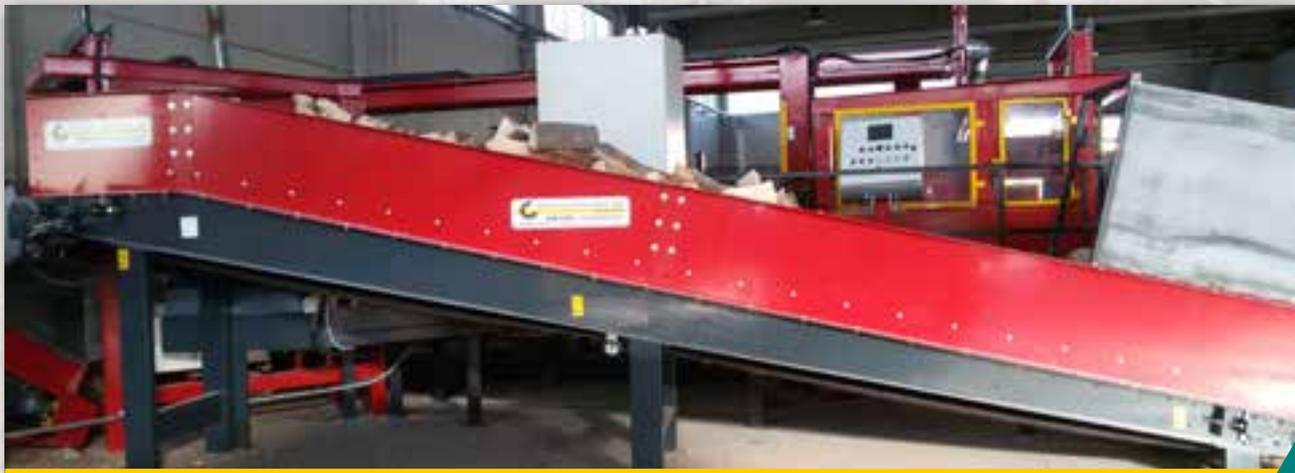
Nastro di accumulo per il contenimento del materiale segato da trasportare alle spaccalegna.
