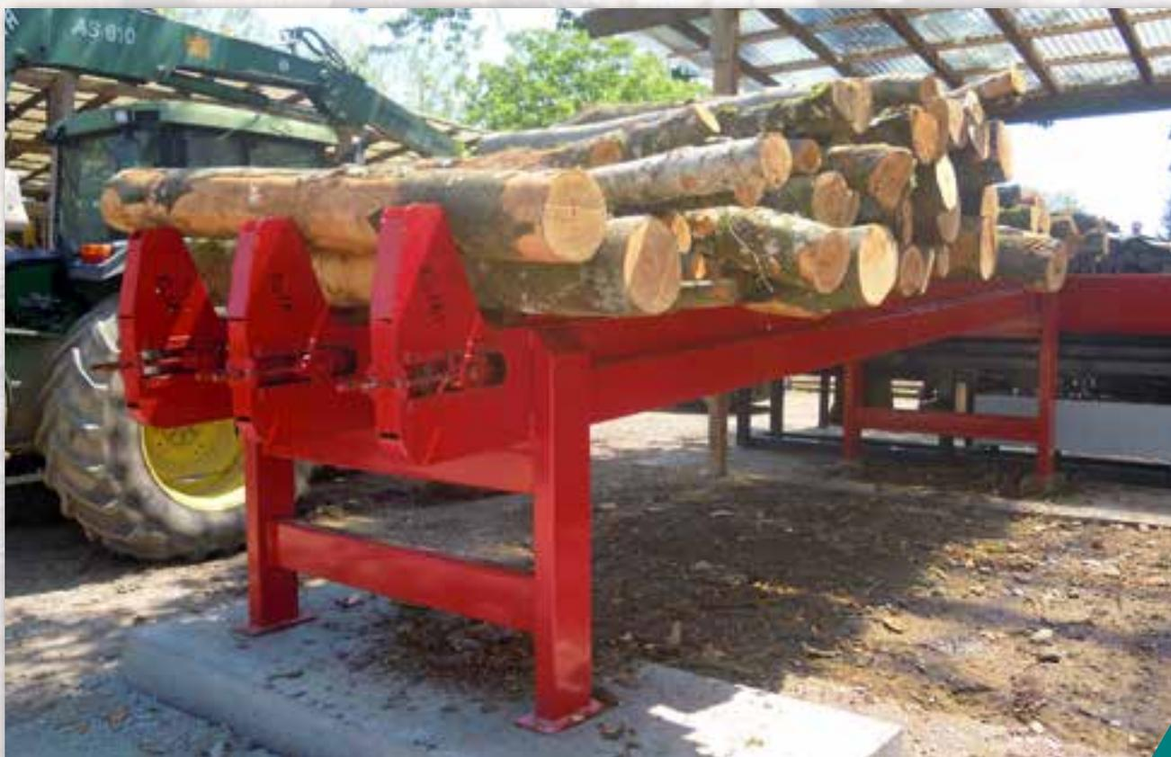
Caricatori a catene per il trasporto del materiale da lavorare alla macchina, con dimensioni e caratteristiche adatte di volta in volta alle esigenze del cliente. Comando mezzo motoriduttore idraulico, con corone in acciaio e catena pesante.
