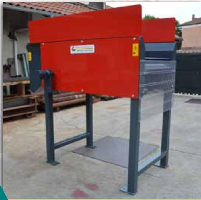
Sistema di pulizia, composto da telaio robusto, con N° 8 alberi con 10-11 dischi per albero, a comando idraulico, con catena. Supporti oscillanti sostengono gli 8 alberi, che per mezzo della catena, vengono fatti ruotare da un motore idraulico orbitale. Dimensioni standard, come indicate nel disegno. Interasse alberi 140 mm, vagliatura 30 mm. Per azionamento elettrico, centralina oleodinamica 2.2 Kw trifase o monofase.
