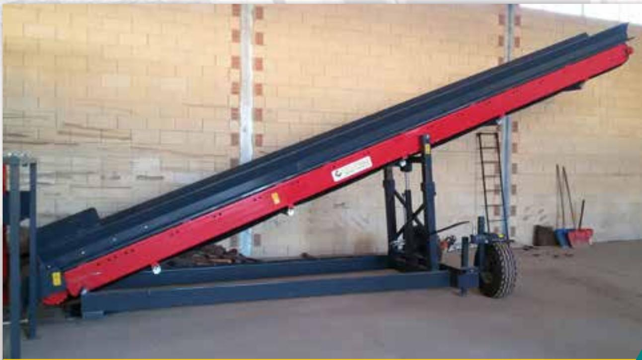
Nastro scala in gomma nera spigata, a comando, sollevamento e traslazione laterale idraulico. Dimensioni standard larghezza 600 mm, lunghezza 8 metri.
