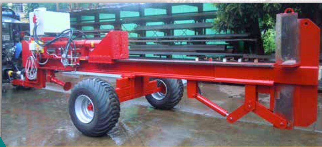
Spaccalegna 40 t, corsa 2,6 metri, azionamento trattore, con radiocomando, coltello 2-4 a movimento idraulico.
