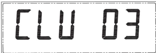
Utilisez **FLÈCHE HAUT** et **FLÈCHE BAS** pour augmenter ou diminuer la valeur du chiffre clignotant ; utilisez **FLÈCHE GAUCHE** et **FLÈCHE DROITE** pour passer au chiffre de droite ou de gauche. Une fois le champ de mémoire choisi, pressez **ENTER** pour confirmer. La balance est maintenant programmée avec la valeur stockée dans ce champ de la mémoire de comptage.
