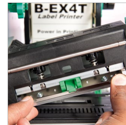
La tête se met en place d'un simple clic pour une remise en route immédiate en cas de maintenance
