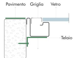
Il **LUCERNARIO** va appoggiato sul muretto o sulla struttura in acciaio per almeno 5 cm.
