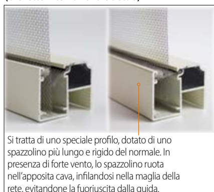
Guida con sistema antivento (brevetto internazionale Bettio)
