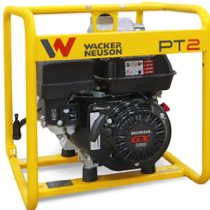
Pompa centrifuga autoadescante a benzina da 2 pollici con motore Honda, per operazioni di drenaggio con solidi fino a un diametro di 25 mm.
