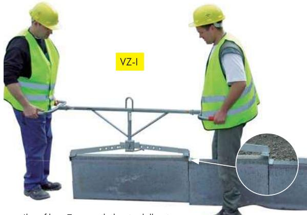
Il profilo a Z causa il rilascio della pinza al momento del posizionamento.
