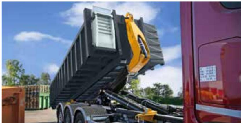
L'option de mouvement rapide augmente les performances lors de l'extension des vérins pendant le chargement ou le bennage. Elle réduit le temps de cycle en permettant un fonctionnement à grande vitesse lors de l'extension des vérins (-50% du temps de cycle). Cette option accélère le flux de travail global et contribue également à une manutention des caissons plus efficace et plus rapide.
