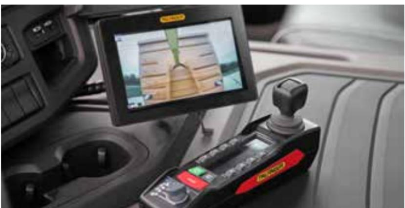
Pour un meilleur contrôle des opérations depuis l'intérieur de la cabine. Le conducteur peut voir avec précision et sans effort ce qu'il fait, grâce aux caméras affichées sur l'écran tactile. L'automatisation de la sélection des caméras fluidifie l'opération et lui permet de rester concentré sur la manutention, afin de pouvoir réagir immédiatement en cas de besoin.
