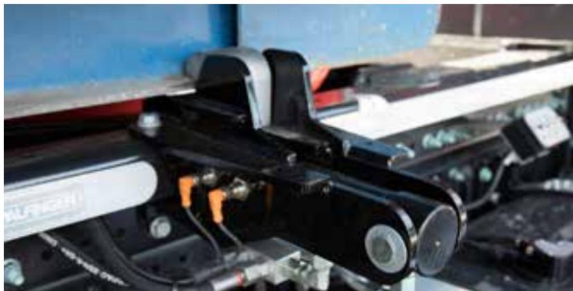
Transport sûr pour des applications spéciales. Le verrouillage avant augmente la stabilité lors du transport de bennes hautes ou dont le centre de gravité est élevé. Il permet également le chargement et l'utilisation de bennes spéciales (grues sur berces, compacteurs sur berces, etc.). La conception boulonnée permet un positionnement plus modulable sur le faux châssis.
