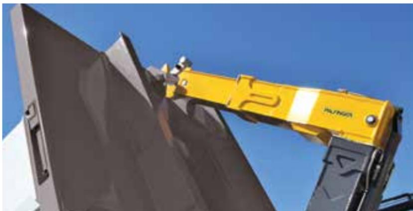
La hauteur variable permet d'ajuster la hauteur du bras pour charger différents types de caisses. Cette option est idéale lorsque la polyvalence est nécessaire : flotte mixte de caisses ou zone frontalière avec différents standards de caisses. Cette option peut être utilisée pour saisir de nouvelles opportunités d'activité et accroître les possibilités de revente.
