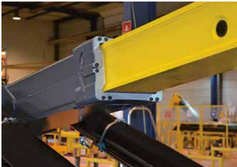
Avant d'être assemblés, les principaux composants sont grenaillés, dégraissés, peints d'une couche d'apprêt et revêtus d'une couche finale (selon les spécifications du client). Toutes les autres pièces sont traitées anticorrosion au zinc-nickel. Bénéficie d'une protection intégrale de 15 ans (ISO12944 classe 3).
