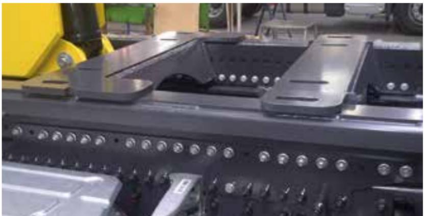
Le châssis renforcé pour le montage de la grue assure une stabilité et une durabilité maximales lors des opérations de levage de charges lourdes. Aucune soudure n'est nécessaire sur le bras de levage lors de l'installation ce qui facilite les opérations de montage. Le choix d'une solution constructeur garantit un fonctionnement optimal de l'ensemble.
