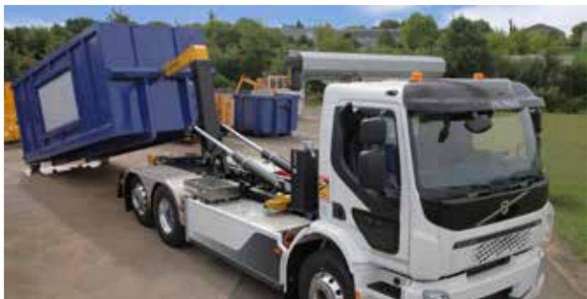
Pour faciliter la manœuvre lors de la phase d'accroche, l'utilisateur peut passer en vitesse lente et gagner en précision lors de l'approche de la caisse. La grande vitesse est utilisée lorsque l'opération le permet. L'utilisateur est plus confiant dans ses opérations et le risque de dommages dus aux impacts est réduit.
