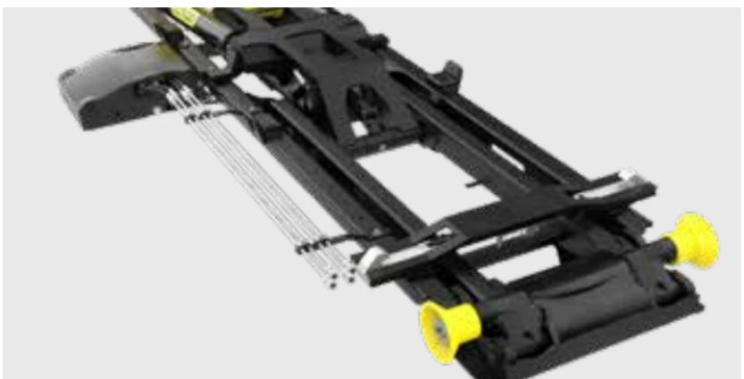
Tuyaux pré-installés en usine à l'arrière gauche de l'équipement pour des fonctions hydrauliques supplémentaires. Ces sections hydrauliques supplémentaires permettent des fonctions additionnelles qui peuvent être facilement branchées sur les raccords hydrauliques, ce qui permet de gagner du temps lors du montage.
