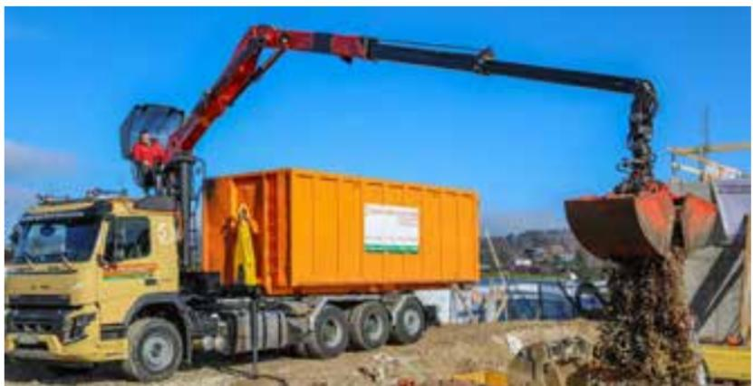
Les bras de levage PALFINGER peuvent être contrôlés à partir d'un dispositif externe, comme une grue, grâce à l'interface du contrôleur PAD. Cela permet d'ajuster la position de la benne avec toute la logique de sécurité incluse, sans quitter l'activité principale pour retourner à la cabine afin de manipuler le bras. L'interface est dotée de fonctions intelligentes pour une intégration et une utilisation efficaces.
