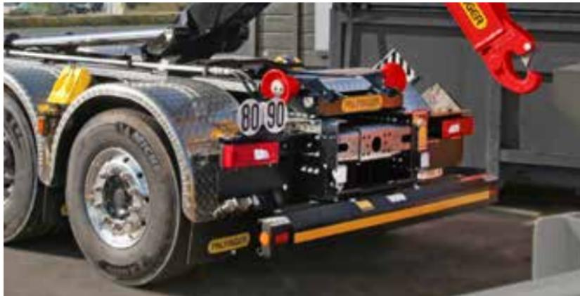
La barre anti-encastrement arrière Palfinger, conforme à la réglementation R58-03, a été conçue pour être particulièrement facile à monter. Cette protection arrière est adaptée aux camions N3.
