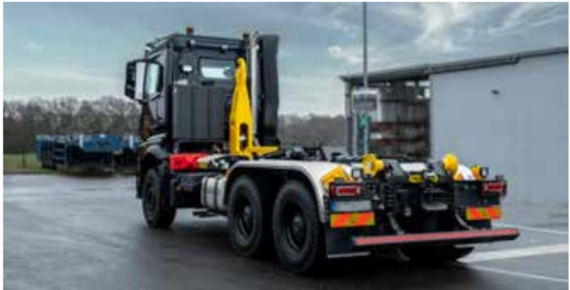
Qu'il s'agisse de décharger, de charger ou de benner, la commande séquentielle automatique du bras de levage PALFINGER exécute automatiquement toutes les fonctions hydrauliques nécessaires, les unes après les autres. Il suffit de sélectionner la fonction, d'actionner le joystick et le cycle de travail est effectué. Les mouvements du bras de levage sont réalisés de manière autonome dans l'ordre prédéfini.
