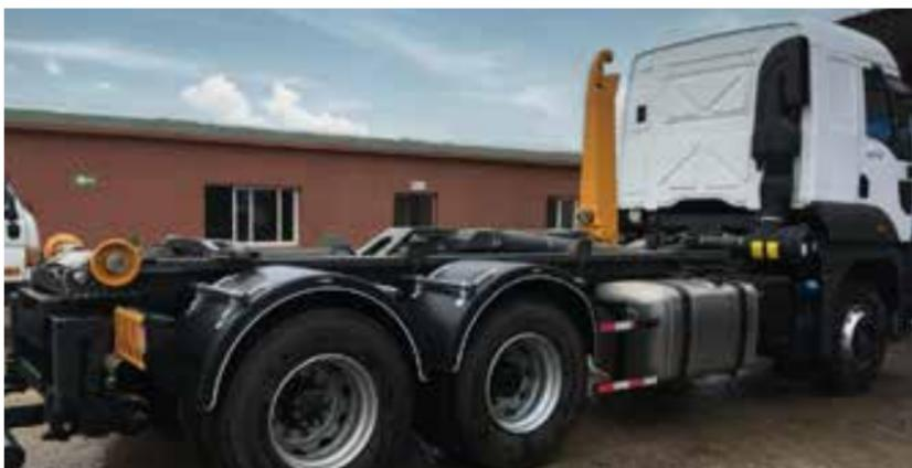
La gamme HD Heavy Duty est spécialement conçue pour travailler dans des conditions difficiles pour des applications tout-terrain sur des camions spécifiques grâce à des composants surdimensionnés. Cette gamme est idéale pour supporter des taux de charge élevés et une utilisation intense, ce qui la rend parfaitement adaptée à de nombreux secteurs exigeants tels que la gestion des déchets, la construction, les travaux publics, l'agriculture et les organisations humanitaires.
