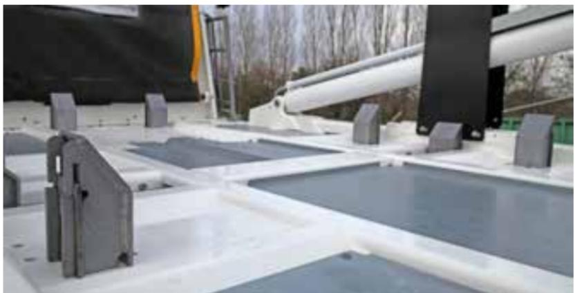
Il est possible de combiner jusqu'à 9 dispositifs de verrouillage situés à des endroits stratégiques de la plate-forme. Des butées mécaniques guident la benne pendant les opérations et le système de verrouillage hydraulique augmente la stabilité pendant le transport.
