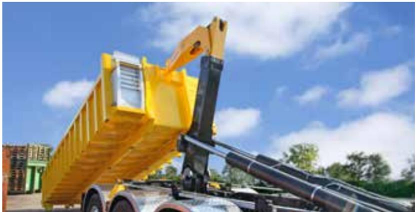
Le système a pour but d'assurer une utilisation sûre du bras articulé et d'éviter les collisions à l'arrière de l'équipement lors de la manipulation de la caisse. Grâce à un système de détection, le conducteur peut opérer dans une zone sûre en fonction de la configuration de son camion sans risquer des dommages sur la structure. Cette option augmente le confort de l'opérateur et facilite la manipulation au quotidien.
