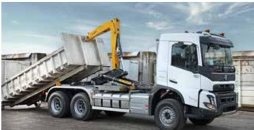
Le système de communication CANBUS entre le camion et le bras de levage permet un câblage facile et sûr, puisque seuls deux fils sont nécessaires. Cette option permet aux carrossiers d'économiser du temps de montage en réduisant le nombre de relais et de jonctions dans le panneau du camion et en accélérant la configuration via le logiciel PALDIAG. Etant l'un des systèmes de communication les plus récents, l'équipement est prêt pour les améliorations des années à venir.
