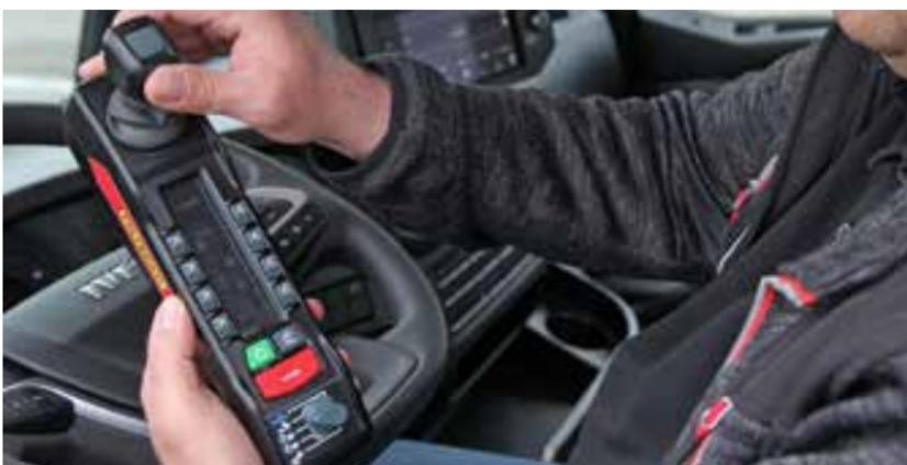
La commande proportionnelle à levier unique offre un grand confort à l'opérateur grâce à des mouvements fluides pendant les opérations. Le contrôle précis du crochet, même à grande vitesse, est particulièrement apprécié lorsqu'il s'agit de travailler dans des espaces exiguës. Les charges lourdes peuvent être manipulées de manière plus sûre et l'option contribue à prolonger la durée de vie des pièces mécaniques.
