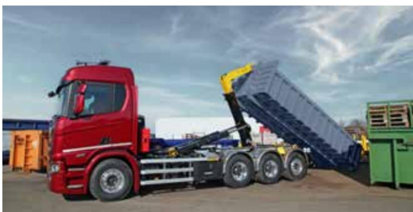
L'option "Soft stop" garantit une arrivée en douceur du caisson sur le camion après le chargement et le bennage. Le camion, le bras de levage et le conteneur sont ainsi protégés contre les chocs et les dommages. Les opérateurs et les personnes aux alentours sont également moins exposés à la pollution sonore.
