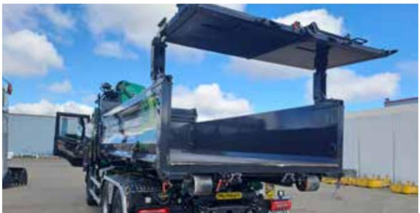
Les fonctions hydrauliques supplémentaires peuvent être pilotées depuis la cabine grâce à la commande V Drive ou à la radiocommande.
