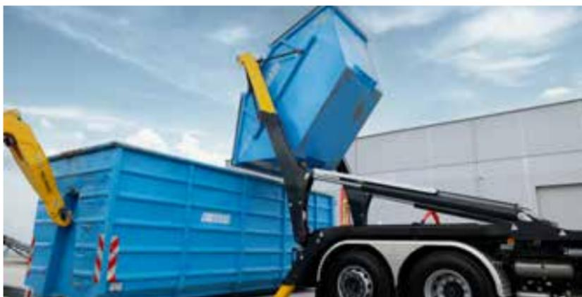
Le bennage en hauteur permet le transfert facile et sûr du contenu d'une benne à l'autre. La sécurité de l'opérateur est assurée par la fonctionnalité intégrée des points d'ancrage des câbles et l'activation à distance via la commande radio.
