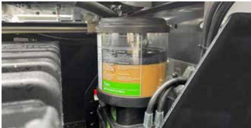
Chaque semaine, jusqu'à 15 points de graissage doivent être lubrifiés sur un bras de levage afin d'améliorer la durée de vie de l'équipement. Pour économiser ce temps de maintenance, un système de graissage centralisé installé en usine est disponible.
