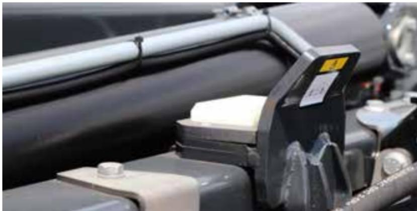
Grâce au support de benne boulonné et anti-friction en polyamide renforcé, le chargement se fait en douceur et en silence, ce qui améliore l'environnement de travail des opérateurs et de leur entourage. La solution boulonnée permet un remplacement rapide et facile.
