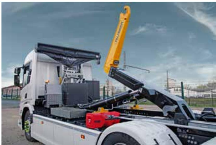
Nous proposons des plaques de montage et des accessoires anticorrosion entièrement boulonnables. SAM (Secured Advanced Mounting) garantit la conformité avec les instructions de montage de PALFINGER et les directives d'assemblage des fabricants de camions. Grâce à sa technologie boulonnée et à sa protection totale contre la corrosion, SAM garantit une qualité élevée et une longévité accrue de l'équipement avec un remplacement facile des accessoires.
