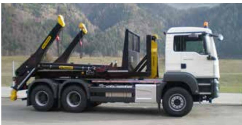
Les multibennes PALFINGER peuvent être installés sur une berce pour ajouter encore plus de polyvalence au camion équipé d'un bras de levage. Cette configuration, disponible sur demande, améliore le temps de fonctionnement du camion et facilite la logistique.
