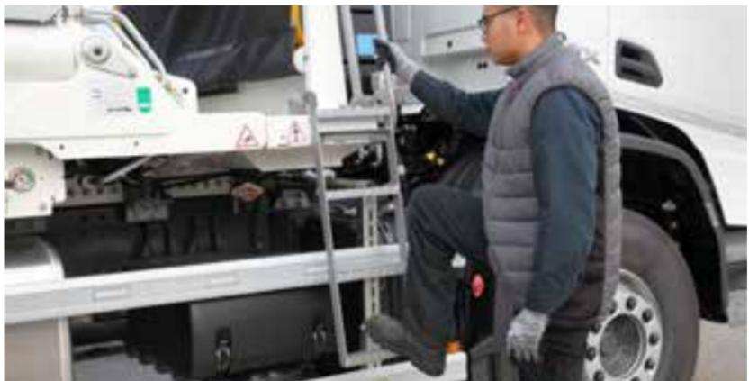
Différents types d'échelles sont proposés pour faciliter l'accès à la plate-forme des deux côtés du camion. Les versions basculantes ou coulissantes sont faciles à déployer et la main courante sécurise l'accès. Des combinaisons de versions et de positions sont également proposées pour s'adapter à chaque besoin.
