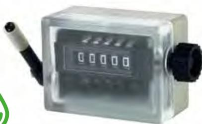
Contacolpi IP 54 • senso di rotazione via o verso • misura utile 99.999 colpi (+1 torna a zero) • rimessa a zero a corona • altezza cifre 4,5 mm • velocità massima di conteggio: 1000 battute al minuto • misure di ingombro 62 x 45 x 30 mm • interasse fori fissaggio 33 mm • posti sotto la cassa
