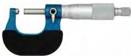
Letture 1/100 di mm • precisione secondo norme DIN 863/1 • una superficie di contatto in widia lappate  $\varnothing$  6,5 mm, l'altra superficie è bombata • bloccaggio a leva • chiavetta per azzeramento • confezione in astuccio
