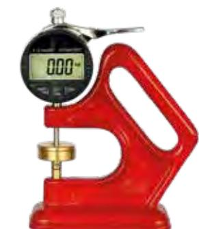
Lettura 1/100 di mm • corsa 10 • movimento rapido a leva • base mm 110 x 54 • arco 40 mm di apertura e 50 mm di profondità
