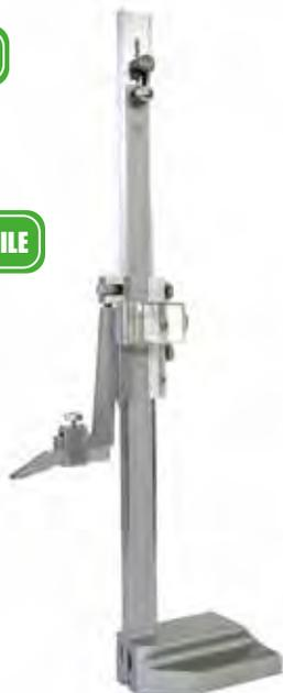
Asta millimetrata incassata e scorrevole con regolazione micrometrica per la ripresa delle misure • base pesante in ghisa verniciata e rettificata • asta e corsoio cromati opachi • acciaio inossidabile con divisione millimetrata • corsoio monoblocco con spostamento micrometrico e vite di bloccaggio • nonio 1/50 • porta punta regolabile con vite di bloccaggio • punta per tracciare widia
