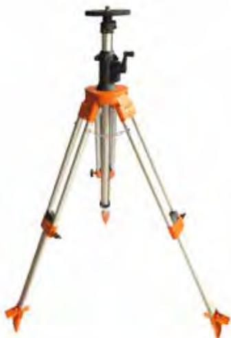
Costruiti in duralluminio • colonna centrale elevabile a cremagliera con manovella per 50 cm • ghiera di bloccaggio • testata piana • puntali pressofusi con pedana di appoggio per facilitare l'infissione nel terreno • gambe estensibili ossidate anodicamente • foro centrale per piombo laser • completo di cinghia per trasporto
