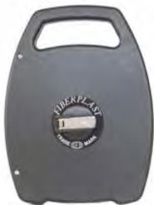
Grado di precisione secondo le norme CEE • CL III • larghezza nastro 15 mm • con rinforzi in fibra di vetro • astuccio e maniglia in ABS antiurto • nastro centimetrato sulle due facce con suddivisione ogni 5 mm • riporto dei metri in rosso
