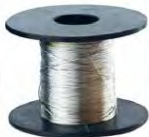
Funi acciaio inox  $\varnothing$  0,30 mm • numero fili 7 x 0,10 mm • resistenza a 1770/N per  $\text{mm}^2$  • carico di rottura 8 kg
