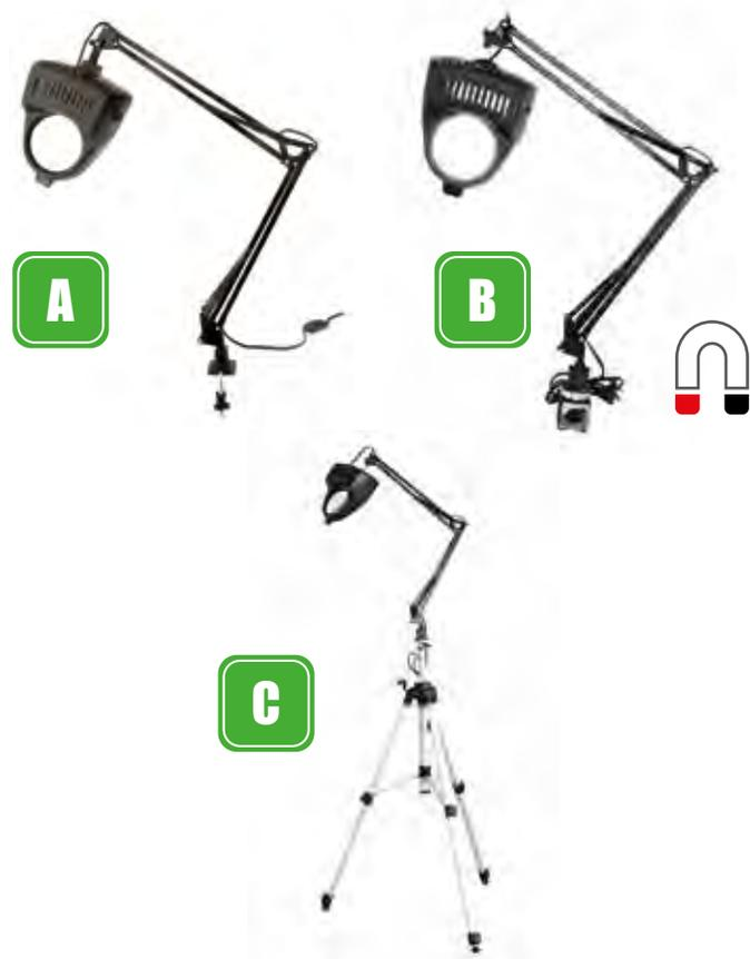
Riflettore snodato • braccia snodate ed equilibrate a compensazione di molle • lunghezza 1 metro • lente in vetro ottico con ingrandimento X 1,5 • ø della lente 100 mm • attacco E 27 Max 40 W • conforme alle norme C.E.I. 34-21.
