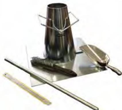
Il Cono di Abrams è uno stampo a forma di tronco di cono che serve a determinare la consistenza del calcestruzzo fresco • la consistenza del calcestruzzo è la resistenza che la massa oppone al cambiamento di forma dovuto al proprio peso, mentre la lavorabilità è la caratteristica reologica (scorrimento) più importante che indica la capacità del calcestruzzo fresco di muoversi e compatarsi a seguito di una sollecitazione meccanica
