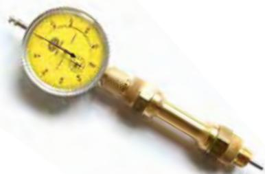
Rilevatore del punto morto superiore della corsa dei pistoni nei motori a scoppio • comparatore 1/100 • corsa utile 10 mm • per l'impiego si alloggia al posto della candela
