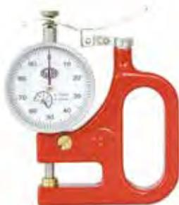
Lettura 1/100 di mm • comparatore Ø 40 mm • apertura 5 mm • profondità 20 mm • movimento rapido a leva • contatti a piattello Ø 8 mm • quadrante girevole per azzeramento
