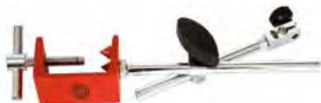
Morsetto portacomparatore a braccio snodato estensibile ed orientabile • apertura utile per bloccaggio morsetto 42 mm profondità 22 mm • colonna 150 mm • braccio snodato 150 mm
