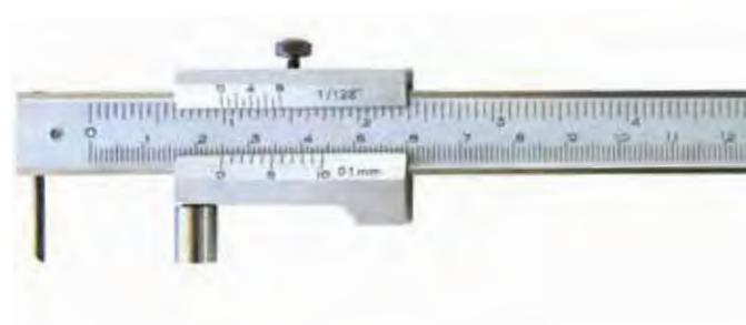
Per rapide e precise operazioni di tracciatura • esecuzione in acciaio inox cromato opaco • punta per tracciare in metallo duro a coltello • graduazione millimetrata • bloccaggio a vite • nonio 1/10 mm • confezione in astuccio
