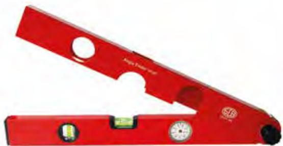
Rilevatore di angoli con bracci sormontabili • lettura immediata sul quadrante ad orologio • campo di misura da 0° a 180° • risoluzione 1° • due fiale acriliche: una verticale ed una orizzontale • vitone per bloccaggio della misura rilevata • fornito con astuccio
