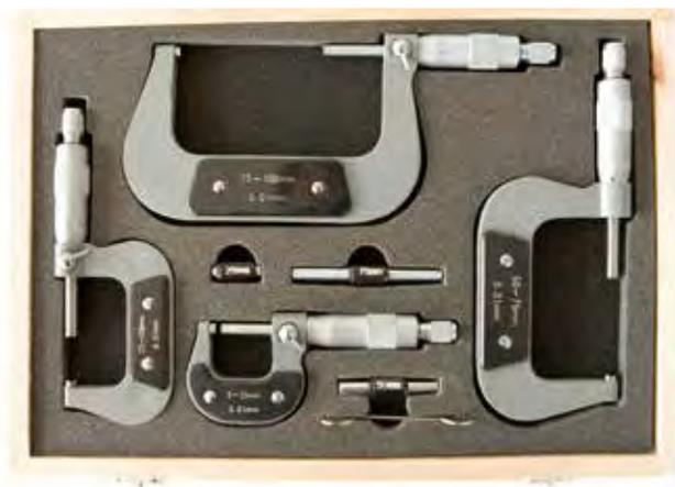
Precisione secondo norme DIN 863/1 • vite micrometrica temperata e rettificata passo 0,5 mm • superfici di contatto in widia lappate  $\varnothing$  6,5 mm • bloccaggio a leva • riscontro di controllo e chiavetta per azzeramento • campo di misura da 0 ÷ 100 • confezione in astuccio
