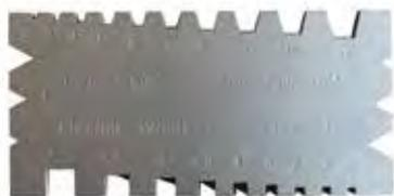
Calibro per filetti Whitworth • metrici trapezoidali da 2 - 12 mm e per filetti quadri da 2 a 8 spire per inch
