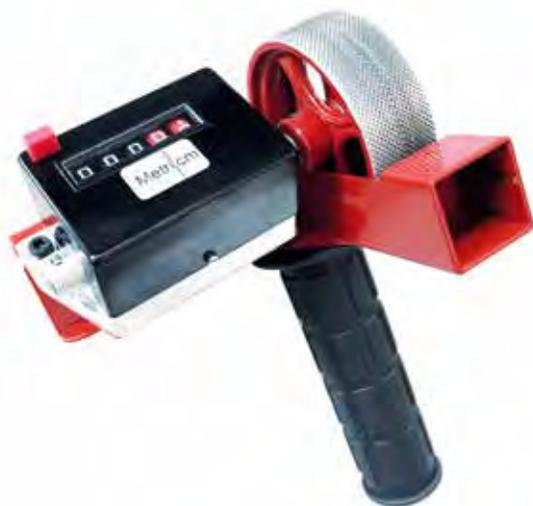
Contacavi portatile • dotato di impugnatura che permette facilità di movimento all'operatore • totalizzatore misura utile 999 m + 2 decimali (dm + cm) • altezza cifre 4,5 mm • addiziona tirando il cavo verso l'operatore • azzeramento del totalizzatore mediante pulsante • diametro massimo misurabile 18 mm
