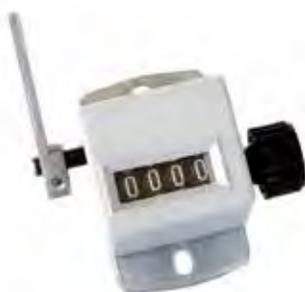
Senso di rotazione via o verso • misura utile 9.999 colpi (+1 torna a zero) • rimessa a zero a bottone • altezza cifre 4 mm • velocità massima di conteggio: 700 battute al minuto • misure di ingombro 28 x 45 x 24 mm • interasse fori fissaggio 35 mm
