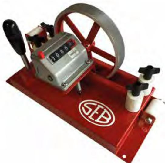
Contacavi da banco • totalizzatore misura utile 9999 m • 4 cifre + 2 decimali • altezza cifre 8 mm • addiziona tirando il cavo verso l'operatore • azzeramento del totalizzatore mediante pulsante • guidacavi regolabili sia in entrata che in uscita per adattarsi ad ogni diametro di cavo • diametro massimo misurabile 23 mm
