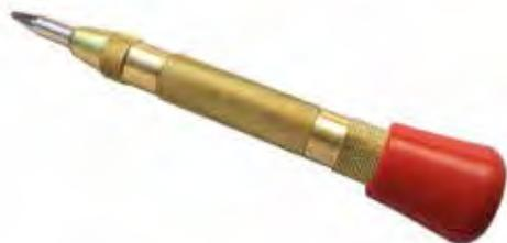
Il bulino automatico a percussione, permette all'operatore di preparare la superficie da forare, evitando l'uso del martello e punta tradizionale • appoggiando e premendo il bulino nel punto desiderato, si provocherà un colpo che andrà a creare l'invito per la foratura
