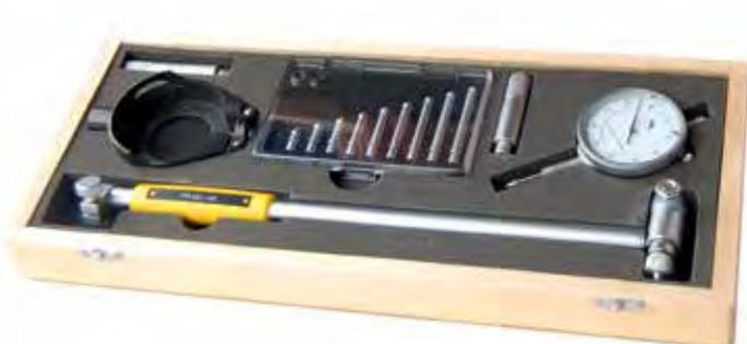
Alesametri centesimali per il controllo di cilindricità, ovalizzazioni, conicità di diametri interni • astine tastatrici intercambiabili progressive con contatto a sfera • guide con contatti in acciaio temperato • centratura ottenuta con contatto su 3 punti • alta sensibilità • lettura 1/100 mm • confezione in astuccio
