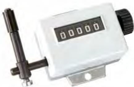
Senso di rotazione via o verso • misura utile 99.999 colpi (+1 torna a zero) • rimessa a zero a corona • altezza cifre 4,5 mm • velocità massima di conteggio: 1000 battute al minuto • misure di ingombro 53 x 36 x 26 mm • interasse fori fissaggio 45 mm
