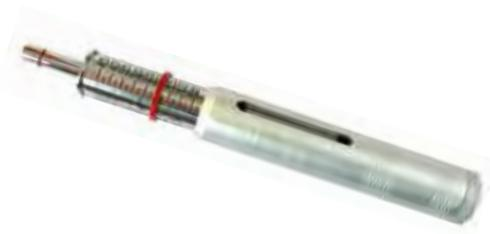
Il penetrometro serve per classificare i tipi di suolo secondo la rispettiva resistenza alla compressione - sulla scala graduata si legge direttamente la resistenza alla compressione in tonnellate per piede quadrato oppure in kg per cm<sup>2</sup> • campo di misura da 0 ÷ 4,5 kg/cm<sup>2</sup>
