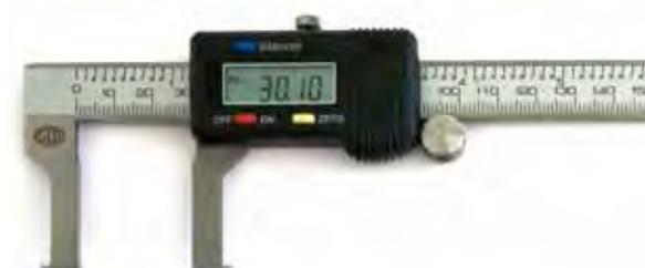
Precisione secondo norme DIN 862 • lunghezza dei becchi 40 mm • ogni becco con prominente punte 3 mm • campo di misura da 20 mm ÷ 150 • azzeramento in qualsiasi posizione • risoluzione display 1/100 di mm • conversione scala mm/poll
