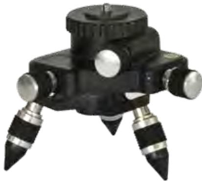
Base con tre punti di appoggio regolabili • attacco superiore da 1/4" • foro inferiore da 5/8" • la base trasla su due assi X e Y di circa 15 mm • rotazione a 360° con spostamento micrometrico • ideale per i laser 3D
