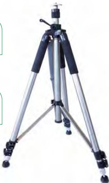
Costruiti in duralluminio • colonna centrale elevabile a cremagliera con manovella per 44 cm • vite di bloccaggio • testata piana diametro 7 cm • bolla sferica sensibilità 1,8 mm/m • foro centrale per piombo laser • gambe estensibili • puntali regolabili per qualsiasi tipo di superficie, terreni e pavimenti • custodia per il trasporto
