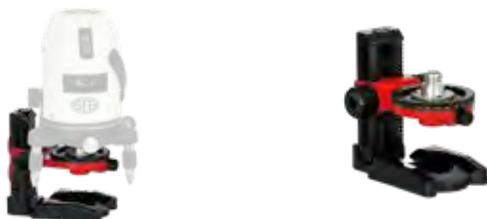
Supporto magnetico con scorrimento regolabile di 7 cm, base rotante graduata, attacco 5/8" con foro passante, livella, foro per fissaggio a parete
