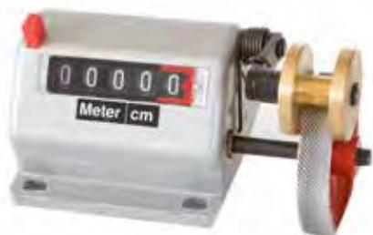
Contacavi da banco • fissaggio a sbalzo • totalizzatore con misura utile 999,99 m • altezza cifre 8 mm • addiziona tirando il cavo o la piattina verso l'operatore, sottrae tirando nel senso opposto • adeguare la velocità di trazione per evitare slittamenti • braccio snodato con molla di pressione per rocchetto guidacavo su ruota alluminio zigrinata • azzeramento del totalizzatore mediante pulsante • interasse fori di fissaggio 70 x 68 mm
