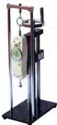
Lo stativo con regolazione micrometrica consente di effettuare prove di carico e di rottura
