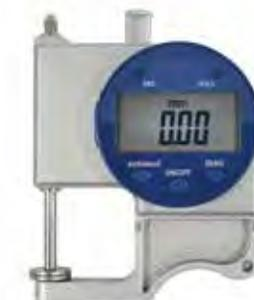
Lettura 1/100 di mm • digitale • movimento rapido • apertura 25 mm e profondità 30 mm • contatti piani Ø 10 mm • dimensioni 80 x 90 x 28 mm • funzioni: mm/inch, azzeramento in qualsiasi posizione, ABS, memoria
