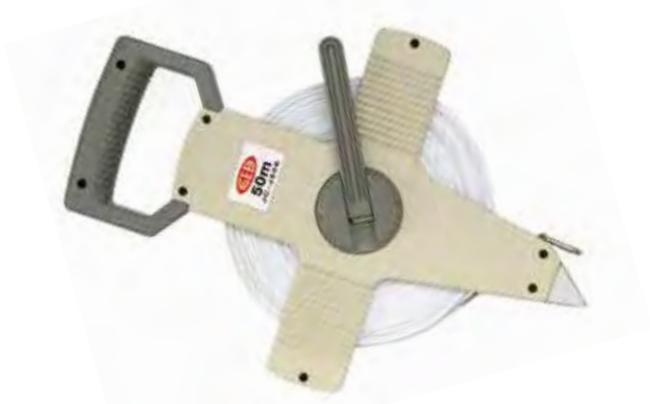
Grado di precisione secondo le norme CEE • CL III • larghezza nastro 12,5 mm • astuccio e maniglia in ABS antiurto • nastro graduato sulle due facce con suddivisione ogni 2 mm • riporto dei metri in rosso
