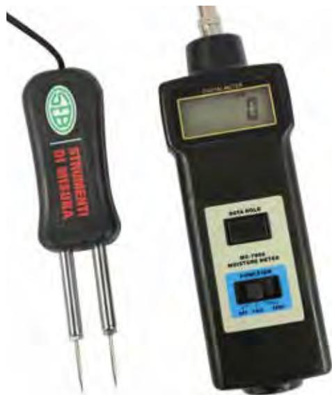
Strumento rilevatore della percentuale di umidità presente nel cemento, muri, intonaci, legno, carta • opera mediante una sonda a 2 puntali da appoggiare o penetrare (per quanto permesso dalla consistenza) nei materiali in esame • i dati forniti sono indicativi e non assoluti, permettono all'operatore di valutare i valori di U.R. delle zone in esame • display LCD • **2 puntali ricambio inclusi**
