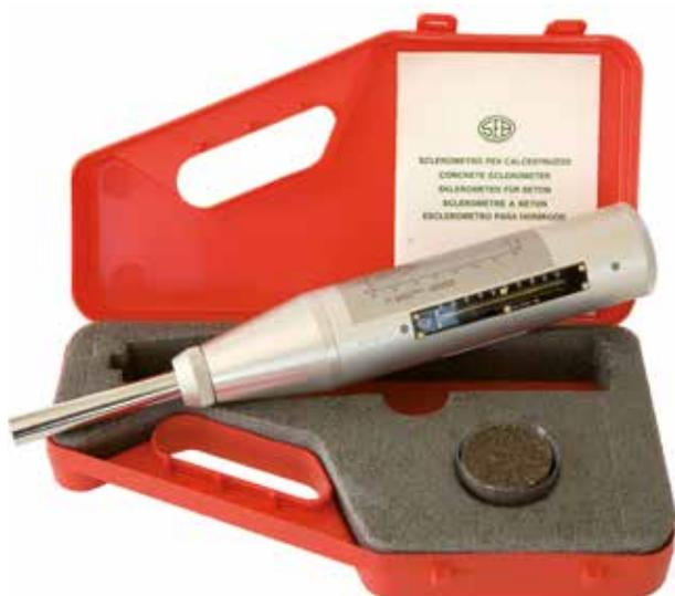
Lo sclerometro verifica con prove non distruttive la resistenza del calcestruzzo nelle costruzioni ultimate, riportando sulle curve del diagramma i valori di rimbalzo ottenuti • si ricava la resistenza alla compressione espressa in  $\text{kg/cm}^2$  (oppure  $\text{N per cm}^2$ ) • è possibile seguire, dopo il disarmo, la curva di indurimento del getto.
