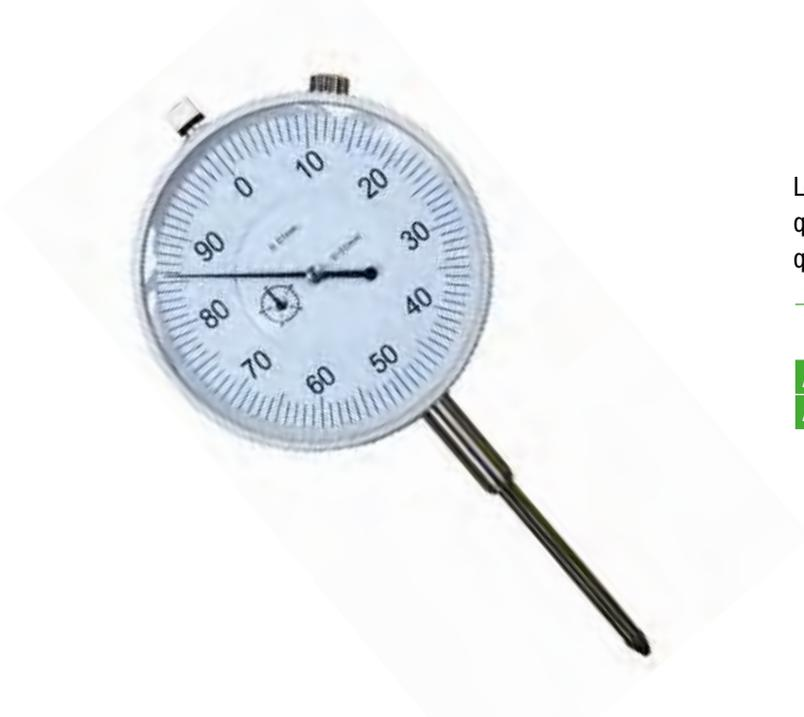
Lettura 0,01 mm • precisione secondo norme DIN 878 • doppio quadrante centrale • due lancette, quella corta indica i millimetri, quella lunga i centesimi di mm
