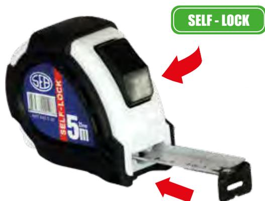
Grado di precisione secondo le norme CEE • classe II • custodia in ABS antiurto ricoperta in gomma • divisione a millimetri • nastro antiriflesso smaltato bianco con decimali rossi. Estruendo il nastro, si blocca automaticamente. Il rientro del nastro avviene premendo uno dei due pulsanti • clip per aggancio e cinghietta
