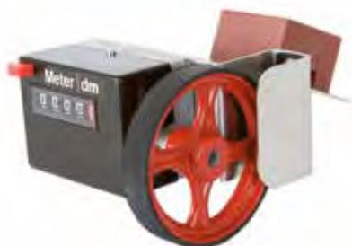
**Impiego:** utile da far scorrere davanti ad una serie di rotoli di cavi diversi • totalizzatore con misura utile 9999 m • a 4 cifre più un decimale per i decimetri • altezza cifre 4,5 mm • rotazione costante • azzeramento mediante pulsante • gomma di ricambio Art. 3163 • diametro massimo misurabile 15 mm
