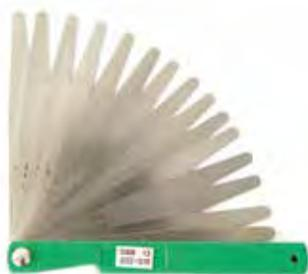
Lame di precisione in acciaio • 13 lame con profilo conico • lunghezza mm 100 • larghezza 12 mm • da 0,02 mm ÷ a 0,1 mm
