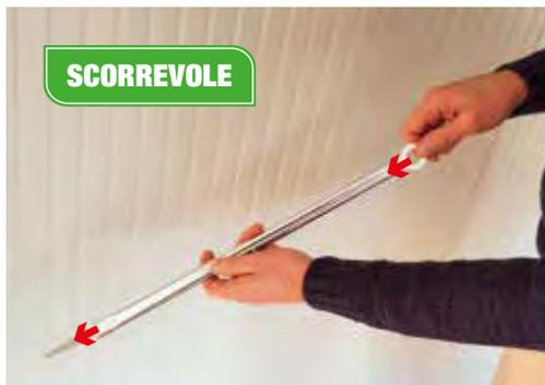
Guaina in metallo cromato • lama con uscita angolata larghezza 12 mm e retrattile mediante asta di scorrimento interna con anello di presa • lunghezza totale 520 mm • spessori delle lame a richiesta da 0,05 mm a 1 mm con progressione di 0,05 mm • indicati per raggiungere punti di difficile accesso, per lavori di controllo e manutenzione grandi motori e macchinari
