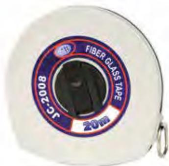
Grado di precisione secondo le norme CEE • CL III • larghezza nastro 12,5 mm • astuccio e maniglia in ABS antiurto • nastro graduato sulle due facce con suddivisione ogni 2 mm • riporto dei metri in rosso
