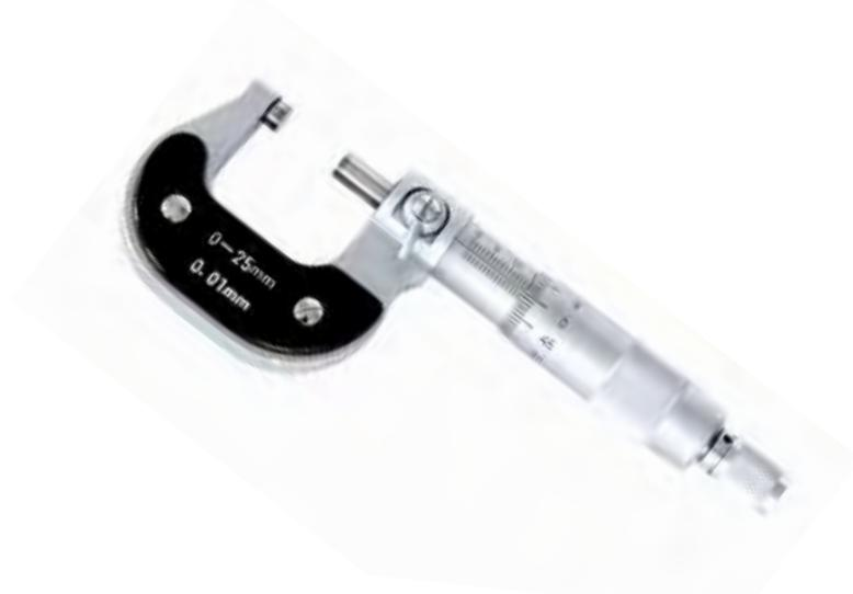
Lettura 1/100 di mm • precisione secondo norme DIN 863/1 • vite micrometrica temperata e rettificata passo 0,5 mm • superfici di contatto in widia lappate Ø 6,5 mm • bloccaggio a leva • riscontro di controllo e chiavetta per azzeramento • confezione in astuccio
