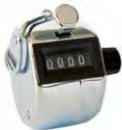
Misura utile 9.999 colpi (+1 torna a zero) • pulsante per far scattare il numeratore • anello sul retro per tenerlo impugnato • bottone rimessa a zero • altezza delle cifre 4 mm • metallo cromato
