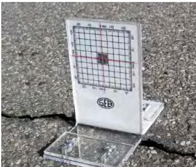
**Lettura 1 mm** • Il fessurimetro consente di monitorare sia il movimento altimetrico a terra sia l'inclinazione verticale di una parete • misura di ogni piastra 100 mm x 65 mm
