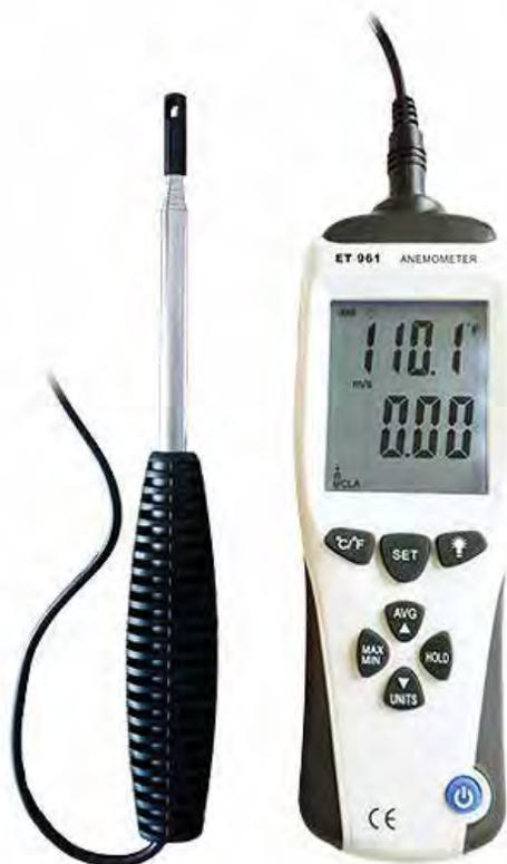
Misura la velocità dell'aria e la temperatura • il micro sensore a filo caldo separato dal corpo dello strumento permette di effettuare letture veloci ed accurate
