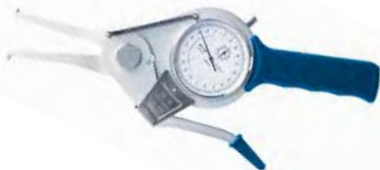
Lettura 1/100 di mm • movimento rapido a leva • quadrante Ø 60 girevole per azzeramento • quadrante piccolo totalizzatore dei millimetri • contatti sferici in metallo duro Ø 3 x 6 mm
