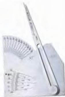
Strumento indispensabile per gli operatori del settore saldatura • misura cordoni di saldatura da 0-50 mm (risoluzione 2 mm) permette la misura di angoli da 30°-90° (risoluzione 5°)
