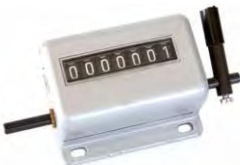
Senso di rotazione via o verso • misura utile 9.999.999 colpi (+1 torna a zero) • altezza cifre 8 mm • albero Ø 7 x 150 mm • comando bilaterale • velocità massima di conteggio: 500 battute al minuto • misure di ingombro 92 x 80 x 50 mm • interasse fori fissaggio 70 x 60 mm
