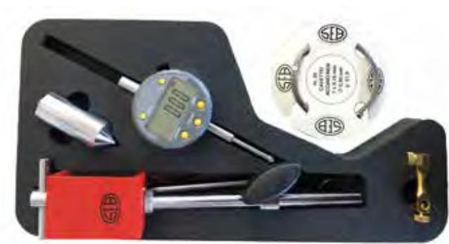
Per le misure delle frecce di flessione e frecce residue nelle costruzioni edilizie in muratura o metalliche • elementi costituenti ogni gruppo di misura: fune acciaio inox inestensibile 20 m • braccetto orientabile per il comparatore • piombo da 200 gr • comparatore digitale lettura 1/100 mm • possibilità di impostare lo zero in qualsiasi posizione • asta snodata da 150 + 150 mm con morsetto luce 40 x 25 mm per fissaggio a tubi o travi • impiego: sia a trazione che a pressione
