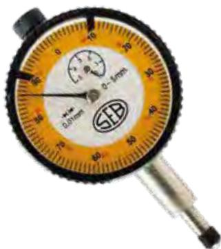
Lettura 0,01 mm • precisione secondo norme DIN 878 • tastatore a sfera intercambiabile con possibilità di applicazione di altri tipi • azzeramento con rotazione del quadrante • 2 lancette
