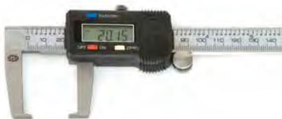
Precisione secondo norme DIN 862 • lunghezza dei becchi 40 mm • prominente punte 5+5 mm • campo di misura da 0 ÷ 150 mm • azzeramento in qualsiasi posizione • risoluzione display 1/100 di mm • conversione scala mm/pollici
