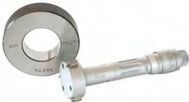
Micrometri millesimali a tre punte per fori ciechi a filo base • i tre punti di contatto disposti a 120° ottengono il centraggio perfetto nel foro in esame e garantiscono alta precisione di misura • completi di anello di azzeramento
