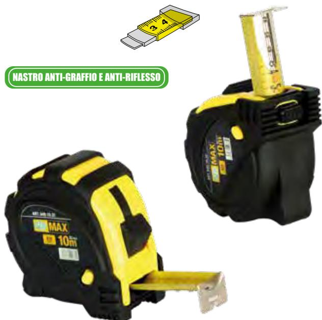
Grado di precisione secondo le norme CEE • classe II • custodia in ABS antiurto ricoperta in gomma • divisione a millimetri su due facce • nastro smaltato giallo antiriflesso con decimali rossi rivestito in nylon • bloccaggio e rientro automatico del nastro • doppio pulsante per rallentare il rientro del nastro • clip per aggancio e cinghietta
