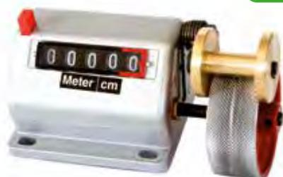
Contacavi da banco • fissaggio a sbalzo • totalizzatore con misura utile 999,99 m • altezza cifre 8 mm • addiziona tirando il cavo o la piattina verso l'operatore, sottrae tirando nel senso opposto • adeguare la velocità di trazione per evitare slittamenti • braccio snodato con molla di pressione per rocchetto guidacavo su ruota in alluminio zigrinata • azzeramento del totalizzatore mediante pulsante • interasse fori di fissaggio 70 x 68 mm
