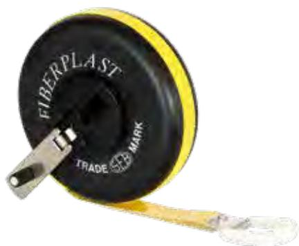
Grado di precisione secondo le norme CEE • CL III • larghezza nastro 15 mm • con rinforzi in fibra di vetro • astuccio e maniglia in ABS antiurto • nastro centimetrato sulle due facce con suddivisione ogni 5 mm • riporto dei metri in rosso
