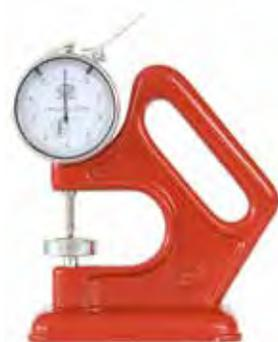
Lettura 1/100 di mm • corsa 10 • movimento rapido a leva • base mm 110 x 54 • arco 40 mm di apertura e 50 mm di profondità
