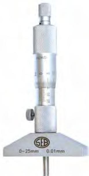
Letture 1/100 di mm • precisione secondo norme DIN 863/1 • superficie di contatto bombata  $\varnothing$  4,5 mm • vite micrometrica corsa 25 mm • vite sensitiva • base di appoggio temperata e rettificata 100 mm • confezione in astuccio
