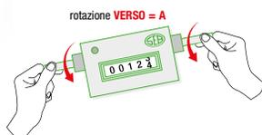
Contagiri: 5 cifre (1 giro = 1 unità) • senso di rotazione via o verso • misura utile 99.999 (+1 torna a zero) • altezza cifre 4,5 mm • albero Ø 3,5 x 100 mm • comando bilaterale • velocità massima di conteggio: 6000 giri al minuto • addiziona in un senso di rotazione, sottrae nel senso opposto • misure di ingombro 67 x 60 x 35 mm • interasse fori fissaggio 50 mm
