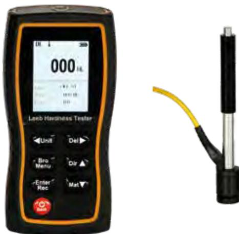
Durometro portatile per il controllo non distruttivo della durezza su differenti tipi di metalli e leghe come acciaio, acciaio inox, fusioni e leghe di alluminio, ghisa, ottone, bronzo e rame • controllo su superfici piane e cilindriche • campo di misura 170-960 hld • scale di durezza hv,hb,hrc,hrb,hra,hs • direzione impatto 0-360° • sonda standard tipo D • 800 memorie
