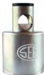
Incudine KRS per controllare la taratura degli sclerometri • durezza di superficie  $>62$  HRC • peso 16 Kg • i valori delle prove devono risultare compresi entro  $78 \div 82$  per gli sclerometri per calcestruzzo, e tra  $68 \div 72$  per gli sclerometri per roccia
