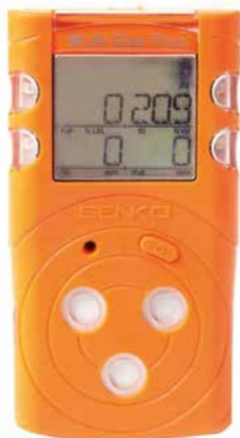
MGT è un rilevatore multi gas portatile per monitorare ambienti pericolosi
