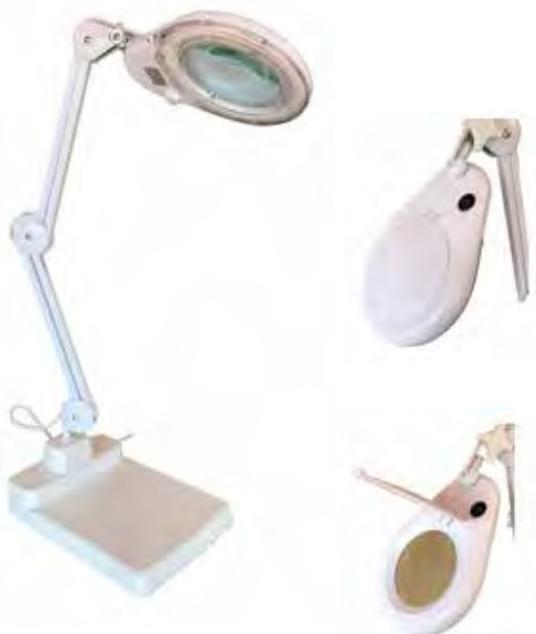
Riflettore snodato • braccia snodate ed equilibrate a compensazione di molle • lunghezza 1 metro • morsetto di regolazione della frizione di bilanciamento in alluminio • morsetto di fissaggio in metallo o base d'appoggio • lente in vetro ottico con ingrandimento X 3 • lente Ø 125 mm • 22 W • conforme alle norme C.E.I. 34-21 • luce fredda basso consumo
