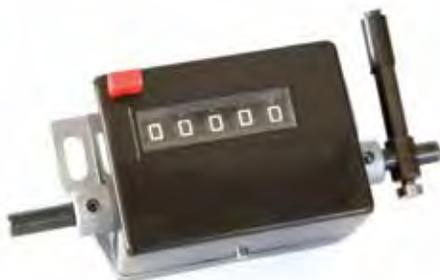
Senso di rotazione via o verso • misura utile 99.999 colpi (+1 torna a zero) • altezza cifre 4,5 mm • albero Ø 6 x 112 mm • albero di comando bilaterale • velocità massima di conteggio: 700 battute al minuto • misure di ingombro 62 x 46 x 36 mm • interasse fori fissaggio 70 mm
