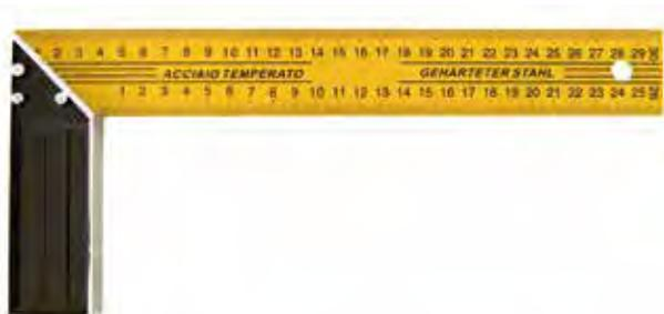
Lama in acciaio temperato 40 x 1 mm • verniciatura smaltata gialla • doppia divisione a millimetri sulle due facce • base in alluminio • piani ed angoli fresati a 90° e 45°
