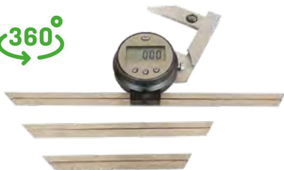
Goniometro digitale acciaio inox, da 0° a 360° selezionabile ( 2 x 180° / 4 x 90° ) • Risoluzione 1' / 0.01° • azzeramento in qualsiasi posizione • memoria • Vite di bloccaggio rotazione • **aste da 150, 200 e 300 mm** scorrevoli e bloccabili in qualsiasi posizione con estremità a 45° e 30° • confezione in astuccio
