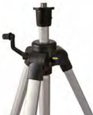
Costruiti in duralluminio • colonna centrale elevabile a cremagliera con manovella per 35 cm • vite di bloccaggio • testata piana diametro 7 cm • bolla sferica sensibilità 1,8 mm/m • foro centrale per piombo laser • gambe estensibili • puntali regolabili per qualsiasi tipo di superficie, terreni e pavimenti
