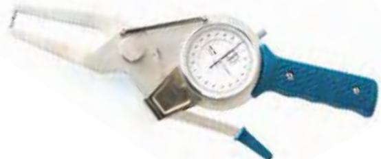
Lettura 1/100 di mm • movimento rapido a leva • quadrante Ø 60 girevole per azzeramento • quadrante piccolo totalizzatore dei millimetri • contatti sferici in metallo duro Ø 3 x 6 mm
