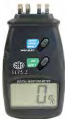
Rilevatore della percentuale di umidità per legno, cartone, carta • lo strumento opera mediante sensori da appoggiare al materiale da testare • risoluzione 1 digit • precisione 1% • campo di misura da 5% ÷ 40% • condizioni di utilizzo da 0°C a 40°C e da 0% ÷ 70% di U.R. • memorizza l'ultimo dato • indicatore di batteria scarica • dimensioni 126 x 70 x 29 mm • peso 150 g
