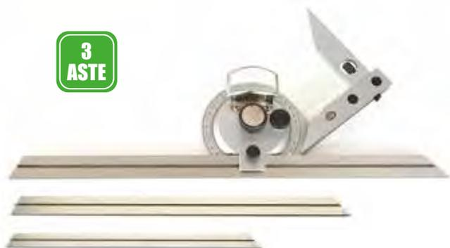
Esecuzione in acciaio inox con graduazione e nonio incisi • cromatura opaca antiriflesso • scala graduata divisa in  $360^\circ$  • numerata 4 volte da  $0 \div 90^\circ$  • lettura del nonio  $1/12^\circ = 5'$  • squadretta scorrevole a  $90^\circ$  con smusso a  $30^\circ$ , bloccabile e sfilabile • **aste da 150, 200, 300 mm** scorrevoli e bloccabili in qualsiasi posizione con estremità a  $45^\circ$  e  $30^\circ$  • confezione in astuccio
