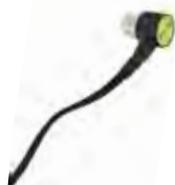
Spessimetro digitale con sonda esterna contatto Ø 10mm per rilevare spessori di materiali come: acciaio, ghisa, alluminio, rame, ottone, zinco, quarzo, PVC, polietilene, vetro • display LCD • campo di misura da 1 ÷ 300 mm • risoluzione: 0,1 mm/0,01 mm selezionabile • accuratezza <math>10 \pm \text{mm} \pm 0,1 \text{ mm} - > 10 \text{ mm} \pm (0,1 + 1\%)</math> • conversione lettura mm/poll
