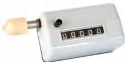
Contagiri: 5 cifre (1 giro = 1 unità) • **addizionale in ambo i sensi di rotazione** • misura utile 99.999 (+1 torna a zero) • altezza cifre 4,5 mm • comando puntale in acciaio ed in gomma • velocità massima di conteggio: 6000 giri al minuto • azzerabile durante il moto • misure di ingombro 67 x 40 x 33 mm
