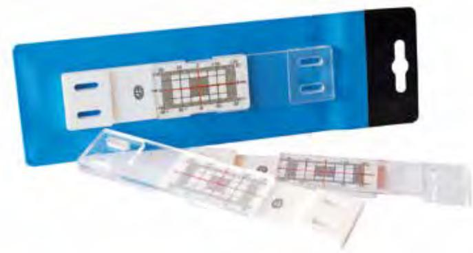
**Lettura 1 mm** • fessurimetro per superfici piane • per seguire l'evolversi delle crepe nei muri • misura di ogni piastra 100 mm x 30 mm
