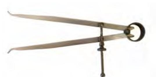
Vite per spostamento metrico delle punte
