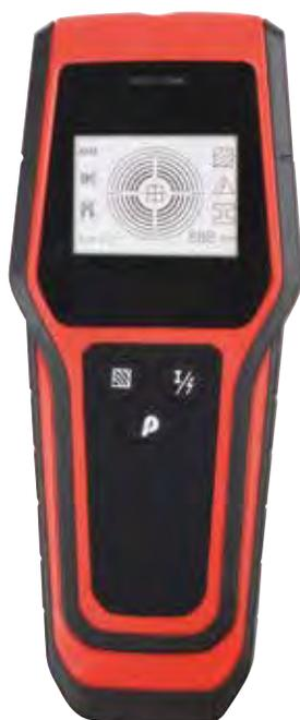
Rilevatore di metalli per la ricerca di tubazioni metalliche e cavi elettrici sotto tensione • indicazione sonora e visiva della profondità della zona in esame • discriminazione di metalli ferrosi e non ferrosi • controllo della sensibilità • display LCD • indicatore di batteria
