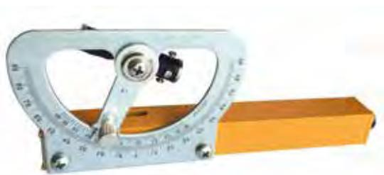
È un clinometro adatto per misure di angoli zenitali fino a 90° sia positivi che negativi rispetto alla linea orizzontale • lettura diretta con nonio • bolla visibile dal cannocchiale • sul settore graduato vi è anche la scala per la lettura delle pendenze sino al 100%, da osservarsi sul settore interno graduato tenendo come riferimento il bordo sinistro dell'indice • esempio: angolo rilevato 45° pendenza= 100%
