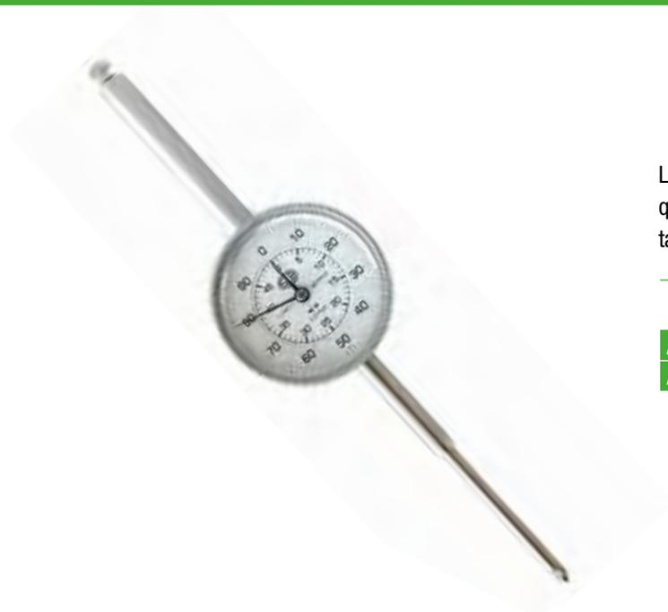
Lettura 0,01 mm • precisione secondo norme DIN 878 • doppio quadrante centrale • due lancette a rotazione centrale, quella corta indica i millimetri, quella lunga i centesimi di mm
