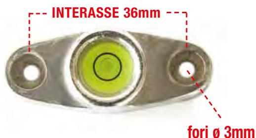
Esecuzione in alluminio • base ovale 47x18 mm • fori di fissaggio • fiala tonda Ø 14 mm • sensibilità fiala 1,8mm/m • liquido colorato
