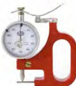
Lettura 1/100 di mm • comparatore Ø 40 mm • adatto per il controllo dello spessore pareti tubi fino a 5 mm con diametro interno minimo del tubo 2 mm • profondità 13 mm • movimento rapido a leva • contatto superiore sferico ed inferiore cilindrico Ø 2 mm • quadrante girevole per azzeramento
