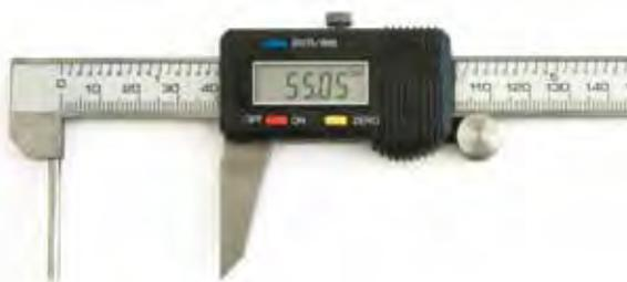
Precisione secondo norme DIN 862 • lunghezza becco tondo 26 mm - Ø 3 mm da introdurre nei tubi • campo di misura da 0 a 150 mm • azzeramento in qualsiasi posizione • risoluzione display 1/100 di mm • conversione scala mm/poll
