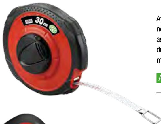
Avvolgimento del nastro 3 volte più veloce • grado di precisione secondo le norme CEE • CL III • larghezza nastro 12,5 mm • astuccio in ABS e gomma antiurto • nastro fibra di vetro • graduato sulle due facce con suddivisione ogni 2 mm • riporto dei metri in rosso
