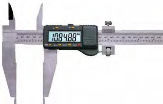
Precisione secondo norme DIN 862 • calibro digitale con vite micrometrica • risoluzione display 1/100 di mm • conversione scala millimetri/pollici • azzeramento in qualsiasi posizione • ABS e PRESET • confezione in astuccio
