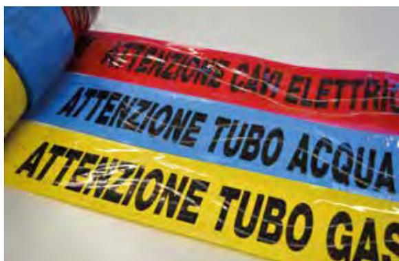
Nastri da interro rilevatori • H 100 mm • lunghezza 150 m • spessore 140 µm con applicati 2 fili inox AISI 304 diametro 0,40 mm rintracciabili da metal detector.
