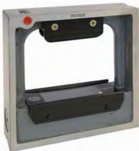
Prodotte secondo norme DIN 877 • struttura in ghisa • quattro angoli di 90° • due basi piane e due prismatiche rettificata • fiale toriche di precisione • piastra di protezione delle fiale, con specifica della sensibilità
