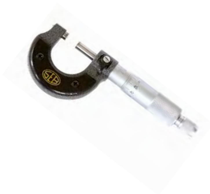
Lettura 1/100 di mm • precisione secondo norme DIN 863/1 • vite micrometrica temperata e rettificata passo 0,5 mm • superfici di contatto in widia lappate Ø 6,5 mm • bloccaggio a leva • riscontro di controllo e chiavetta per azzeramento • confezione in astuccio
