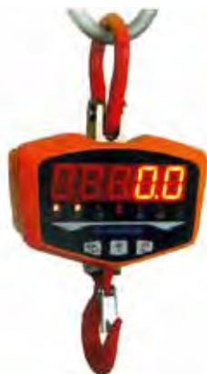
Rispetta standard OIML R-76 • precisione classe III, tara 100% FS, carico massimo 150% FS • limite sovraccarico 50% FS • temperatura impiego -10°C + 40°C • display a LED altamente visibile • cassa in alluminio pressofuso • allarme sonoro • batterie ricaricabili • funzione zero/tara • unità di misura KN/LB/KG • memoria ultima lettura • telecomando e caribatterie
