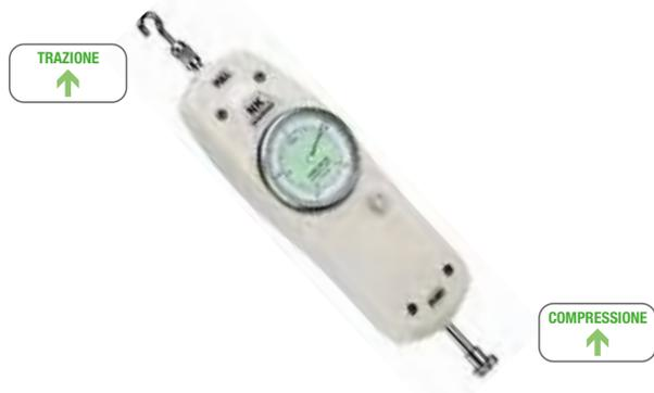
Dinamometri analogici per prove di trazione e di compressione • il quadrante circolare con doppia scala consente la lettura diretta dei valori sia in Newton che in chilogrammi • la lancetta indicatrice può funzionare in due modi: con lettura continua dei valori, oppure con blocco sul valore massimo raggiunto (per fissare valori di eventi rapidi come il picco di carico o la rottura) • precisione  $\pm 1\%$ . Forniti con gancio, piattello, asticella di prolunga
