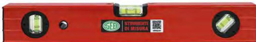
Livella in profilato pesante con nervature • in alluminio verniciato • sezione 60 x 25 mm • tre fiale a doppio tratto in materiale acrilico antichoc • fiale regolabili • precisione 1,8 mm/m • base rettificata
