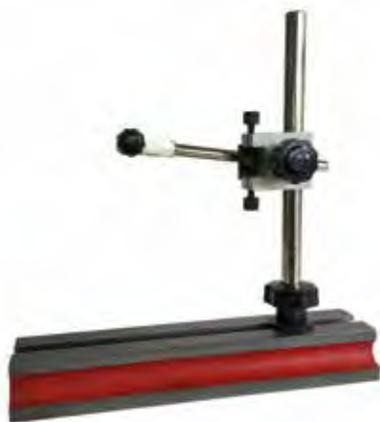
Superfici di appoggio piane e prismatiche rettificate • dispositivo per spostamenti micrometrici • regolazione dell'accostamento contatto del comparatore • bloccaggio della colonna a tirante contro la base • asta snodata girevole allungabile ed orientabile in qualunque posizione • base pesante in ghisa verniciata da 245 x 55 x 42 mm • colonna 220 mm • braccio 160 mm • foro per attacco del comparatore  $\varnothing$  8 H 7 mm
