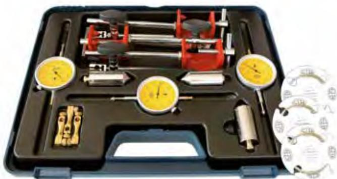
Per le misure delle frecce di flessione e frecce residue nelle costruzioni edilizie in muratura o metalliche • elementi costituenti ogni gruppo di misura: fune acciaio inox inestensibile 20 m • braccetto orientabile per il comparatore • piombo da 200 gr • comparatore lettura 1/100 di mm con quadrante girevole per la messa a zero • asta snodata da 150 + 150 mm con morsetto luce 40 x 25 mm per fissaggio a tubi o travi • impiego: sia a trazione che a pressione
