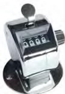
Misura utile 9.999 colpi (+1 torna a zero) • pulsante per far scattare il numeratore • bottone rimessa a zero • altezza delle cifre 4 mm • metallo cromato • base con fori per il fissaggio
