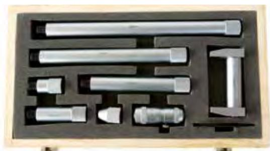
Precisione secondo norme DIN 863/1 • testina micrometrica con vite temperata e rettificata • lettura 1/100 di mm • aste combinabili con contatti sferici temperati • vite di bloccaggio • riscontro per taratura
