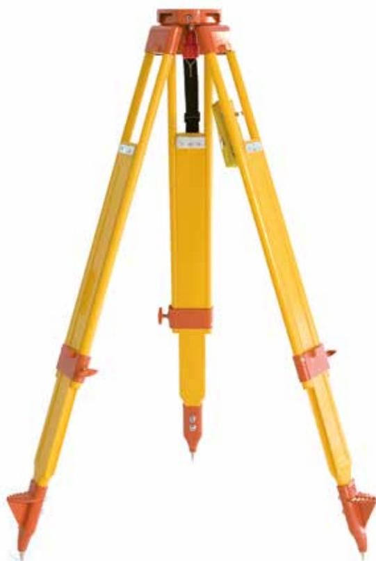
Treppiedi in legno particolarmente adatti per le loro caratteristiche di stabilità a tacheometri e teodoliti • testa piana • vite 5/8" • gambe estensibili da 100 cm a 165 cm • puntali con pedana di appoggio per facilitare l'infissione nel terreno • completo di cinghia per il trasporto • peso 7,7 kg
