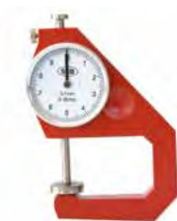
Lettura 1/10 di mm • quadrante Ø 40 mm girevole per azzeramento • vite di bloccaggio • movimento a pressione • molla di contrasto che riporta in apertura i contatti • confezione in astuccio
