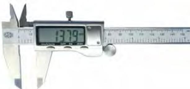
Precisione secondo le norme DIN 862 • calibro digitale con contropunte • accensione e spegnimento con interruttore • autospegnimento • azzeramento in qualsiasi posizione • 4 funzioni: esterni, interni, profondità, spallamenti • risoluzione display 1/100 di mm • conversione scala mm/pollici • confezione in astuccio
