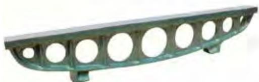
Ghisa stabilizzata • superficie di lavoro rettificata • tolleranza 2/100 di mm • nervature e alleggerimenti realizzati per garantire la stabilità del piano nel tempo
