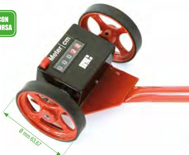
Contametri a due ruote gommate di piccolo diametro (63,67 mm) è molto pratico per rapide e precise misurazioni d'interni (se la misurazione avviene da parete a parete aggiungere il diametro della ruota alla misura rilevata). Il contatore è a 3 cifre per i metri + 2 cifre per i centimetri con pulsante di azzeramento • altezza cifre 4,5 mm • totalizza fino a 999,99 m • rotazione contante e decontante • manico in 2 pezzi • corredato di borsa • peso 1,0 kg
