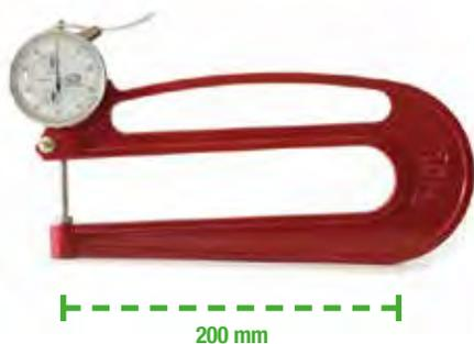
Lettura 1/100 di mm • corsa 30 mm • quadrante girevole per azzeramento • movimento a leva • profondità arco 200 mm
