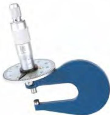
Letture 1/100 di mm • precisione secondo norme DIN 863/1 • campo di misura 0 ÷ 15 mm • profondità arco 50 mm • precisione secondo norme DIN 863/1 • superfici di contatto temperate e lappate  $\varnothing$  7 mm • tamburo  $\varnothing$  20 mm • vite di bloccaggio ad una misura predeterminata • diametro del disco 60 mm • confezione in astuccio
