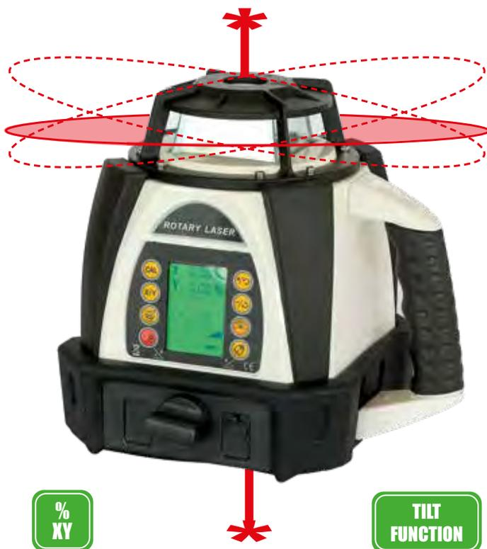
Livello laser autolivellante **per piani orizzontali e verticali** con dispositivo impostazione percentuali inclinazioni dei piani x - y e mediante display LCD. Funzione ADS Tilt permette di memorizzare il punto di stazionamento del laser, in questo modo se lo strumento venisse spostato accidentalmente si blocca automaticamente avvertendo l'operatore del possibile errore
