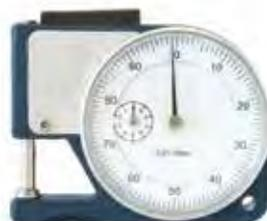
Lettura 1/100 di mm • movimento rapido • apertura 10 mm e profondità 20 mm • quadrante Ø 50 mm girevole per azzeramento • il quadrante piccolo totalizza fino a 10 mm • contatti piani Ø 6 mm • dimensioni mm 54 x 66 x 14 • confezione in astuccio
