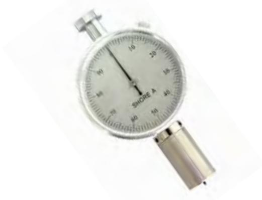
Misuratore per la durezza della gomma • scala Shore A da 0-100 • quadrante girevole per determinare con precisione l'azzeramento • base di appoggio diametro 18 mm • tastatore diametro 1,25 mm • confezione in astuccio
