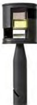
Lo squadro permette di tracciare angoli e fare collimazioni a 90° ed a 180° • il gambo ha un attacco per il filo a piombo oppure può venire montato sulla palina h 1,60 m, mediante il raccordo filettato art. 3690
