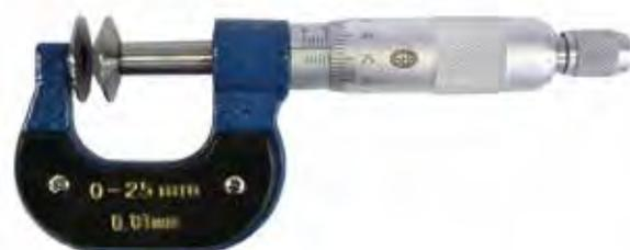
Letture 1/100 di mm • precisione secondo norme DIN 863/1 • contatti a piatello diametro 20 mm • bloccaggio a leva • chiavetta per azzeramento • confezione in astuccio
