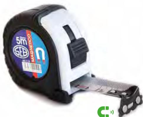
Grado di precisione secondo norme CEE • classe II • custodia ABS antiurto ricoperta in gomma • nastro smaltato bianco • divisione a millimetri • decimali rossi • bloccaggio e rientro automatico del nastro • clip per aggancio e cinghietta • potenti magneti sulla squadretta di testata del nastro
