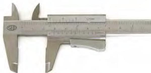
Precisione secondo norme DIN 862 • acciaio inox • asta graduata in mm e poll. • nonio allungato 1/20 di mm e 1/128 di poll. • doppia tabella per le filettature a passo Whit. e S.I. • asta di profondità con smusso terminale per fori • bloccaggio a molla con pulsante • punte a coltello per interni • superfici di lettura satinata opache • 4 funzioni: esterni, interni, profondità, spallamenti • confezione in astuccio
