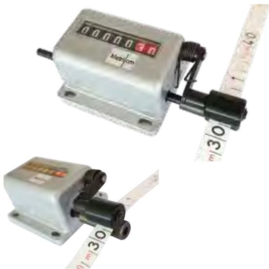
Contametri: 5 cifre + 2 decimali per i decimetri ed i centimetri • rotazione contante e decontante • misura utile 99.999 m (+1 torna a zero) • altezza cifre 8 mm • comando destro o sinistro • tamburo acciaio godronato • rullo di pressione in nylon su braccio a molla • misure di ingombro 92 x 80 x 50 mm • interasse fori fissaggio 70 x 68 mm
