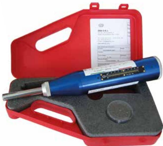
Lo sclerometro LIGHT permette di valutare le caratteristiche qualitative e di resistenza alla compressione su elementi con uno spessore tra 50 e 100 mm o per testare piccoli componenti • inoltre si presta alle misurazioni di strutture in pietra artificiale sensibili agli impatti • il campo di misura va da 10 a 70 N/mm<sup>2</sup> • l'energia di impatto prodotta è di 0,735 Nm
