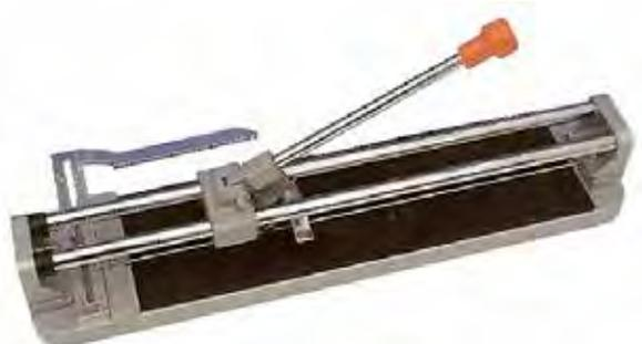
Per piastrelle fino a 500 mm con spessore massimo 16 mm • base in alluminio • diametro delle barre di guida 20 mm • cuscinetti di guida lineare a sfere LM 20 • supporto piastrelle in gomma dura • rotella di taglio in carburo di tungsteno  $\varnothing$  22 mm
