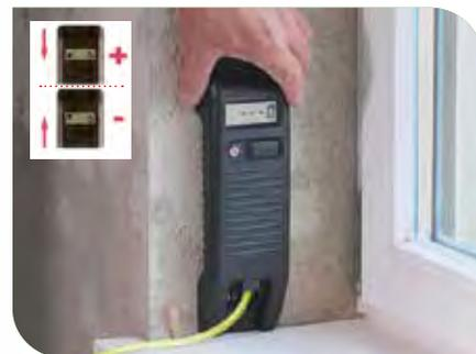
Altimetro digitale per sottofondi • livellamento elettronico con visualizzazione del livello e del dislivello fino a 2,50 m • lettura 1 mm • precisione +/- 2 mm • lunghezza tubo 24 m
