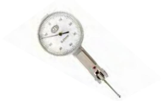
Lettura 0,01 mm • precisione secondo norme DIN 2270 • tastatore inclinabile per 270° con dispositivo di inversione istantanea del senso di rotazione del tastatore • gambo di attacco ∅ 6 e ∅ 8 mm H 12 fissabile su coulisse • quadrante girevole per azzeramento
