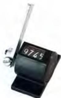
Senso di rotazione via o verso • misura utile 9.999 colpi (+1 torna a zero) • senza rimessa a zero • altezza cifre 4,5 mm • velocità massima di conteggio: 300 battute al minuto • misure di ingombro 19 x 31 x 21 mm • fori fissaggio da farsi nella base che è di materiale plastico
