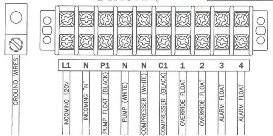
PUMP/COMPRESSER POWER CIRCUIT 115V - 1PH
