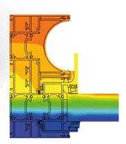
Sistema scorrevole per serramenti a taglio termico con ridottissima mostra architettonica.
