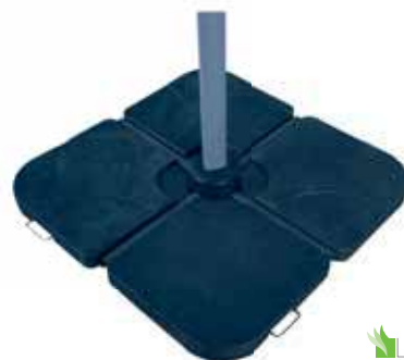
Base per ombrellone plastica Composta da 4 mattonelle PVC, riempibili di sabbia (zavorra max. 88 kg) o acqua (zavorra max.72 kg). Dimensioni: cm 49x49xh.7,5.(x4).
