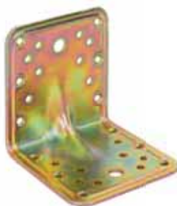
Giunzione ad angolo In acciaio tropicalizzato, mm 103 x 103. Larghezza mm 100, spessore mm 3.
