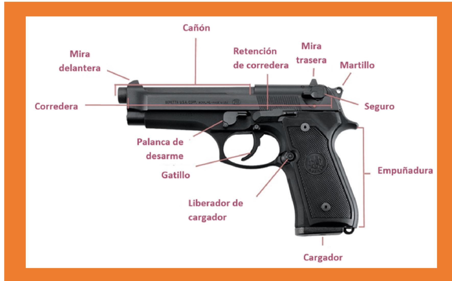
Una pistola es un arma de fuego de corto alcance diseñada para ser utilizada con una sola mano. Generalmente, cuenta con un cañón corto, un mecanismo de disparo que puede ser semiautomático o de acción simple/doble, y un cargador que almacena la munición.
