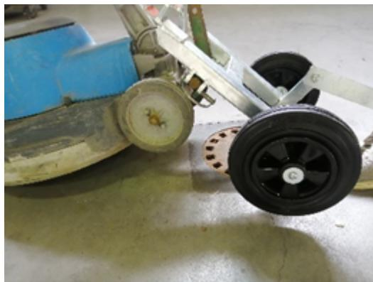
*Image : Placement des pinces dans les ouvertures prévues*
