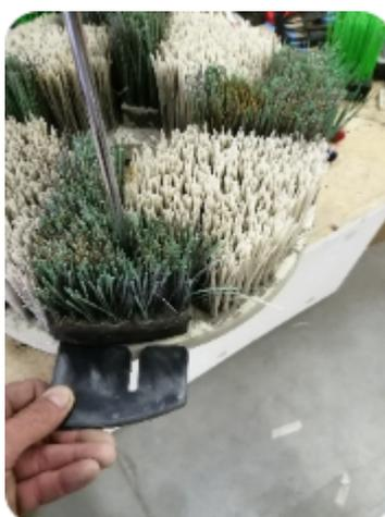
*Image : Placement de la plaque intermédiaire sous la brosse bloc verte*
