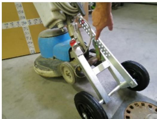
*Image : Placement du boulon à travers le marquage vert*
