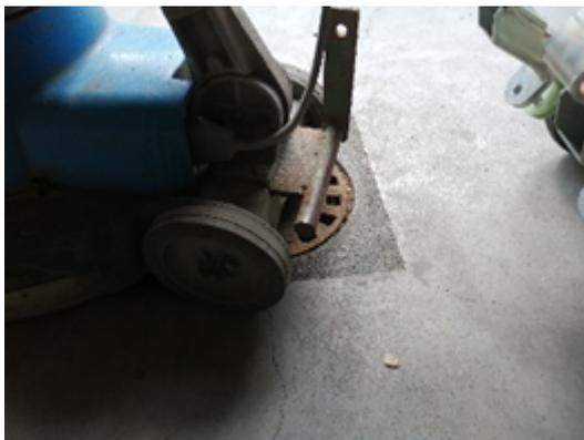
*Image : L'étrier à l'arrière de l'appareil pour la fixation des Handy Wheels*
