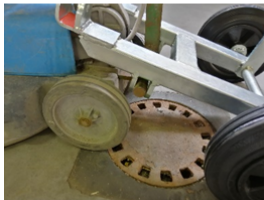
Bild: Platzierung der Handy Wheels mit grüner Markierung nach unten
