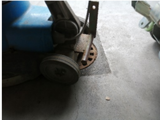
Bild: Der Bügel an der Rückseite des Geräts für die Befestigung der Handy Wheels
