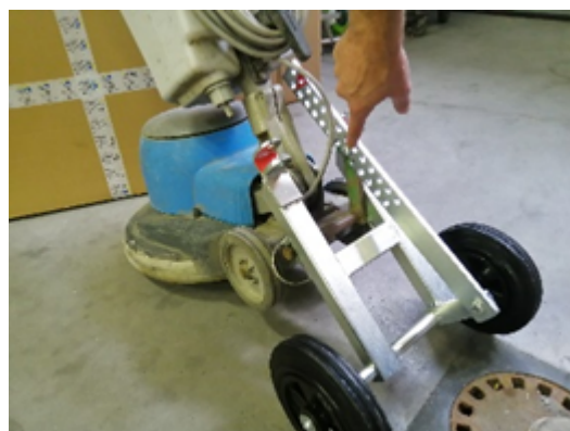
Bild: Platzierung des Bolzens durch die grüne Markierung
