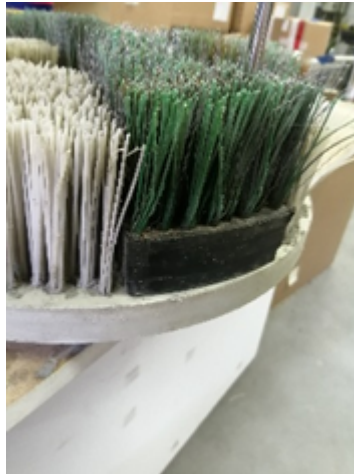
Bild: Korrekt montierte Bürste mit Zwischenplatte
