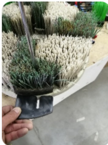
Afbeelding: Plaatsing van de tussenplaat onder de groene blokborstel
