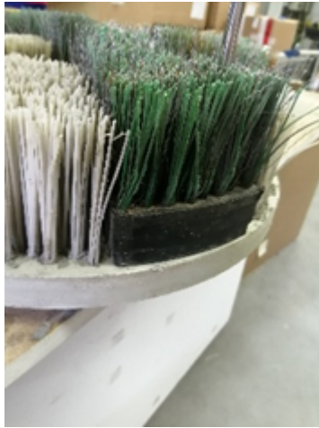
Afbeelding: Correct gemonteerde borstel met tussenplaat
