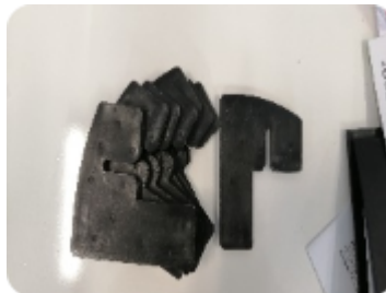
Ophoogplaatjes voor blokborstels te verhogen
