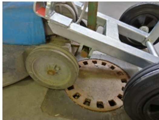
Afbeelding: Plaatsing van de Handy Wheels met groene markering naar beneden
