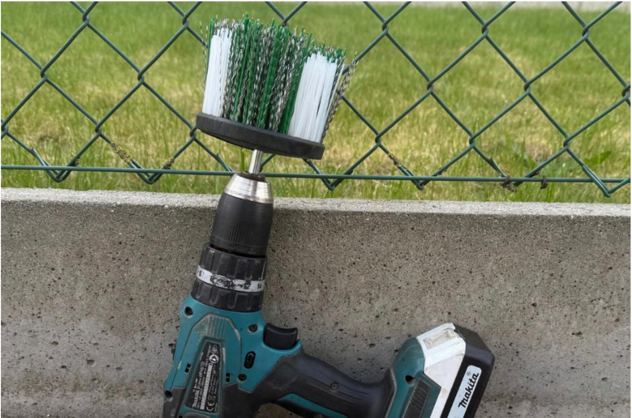
Die MiniBrush verwendet das gleiche Prinzip wie die größeren Terrazza-Maschinen: Lange und kurze Borsten in der Bürste sorgen dafür, dass sowohl die Oberfläche als auch tiefere Rillen und Spalten gründlich gereinigt werden.
