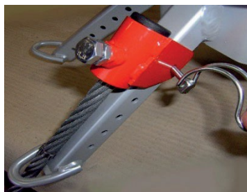
Fig. 4: Montage d'un élément de brosse à fils métalliques tressés
