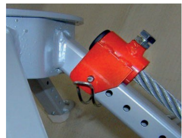
Fig. 4: Montage d'un élément de brosse à fils métalliques tressés
