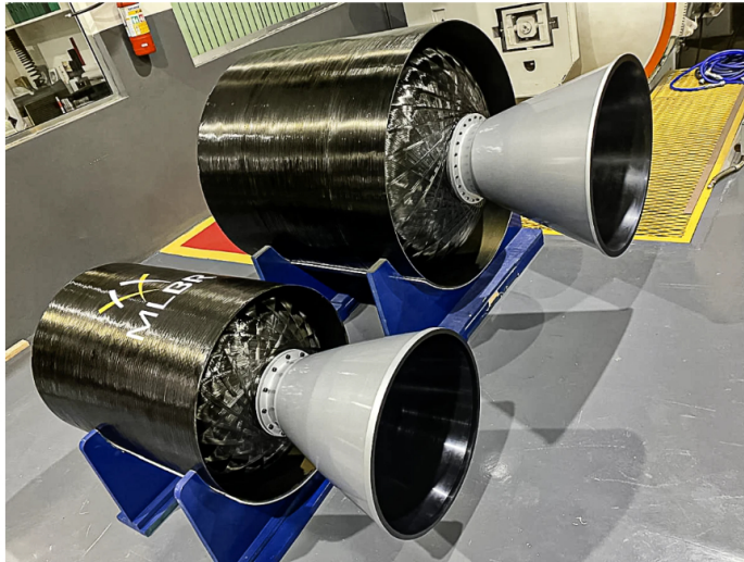
Os motores do 3º e 2º estágio do MLBR. Firma: MLBR
