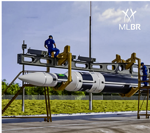
O MLBR na plataforma eretora/lançadora. Firma: MLBR
