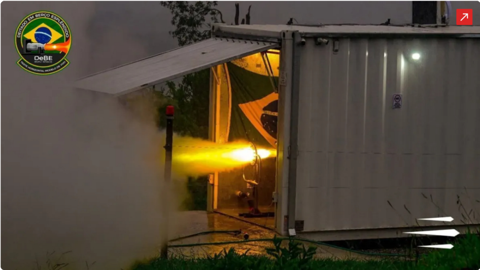
A BIZU Space realizou com sucesso o ensaio de um motor-foguete líquido em seu primeiro modelo de voo, utilizando um motor desenvolvido e fabricado pela própria empresa • BIZU Space
