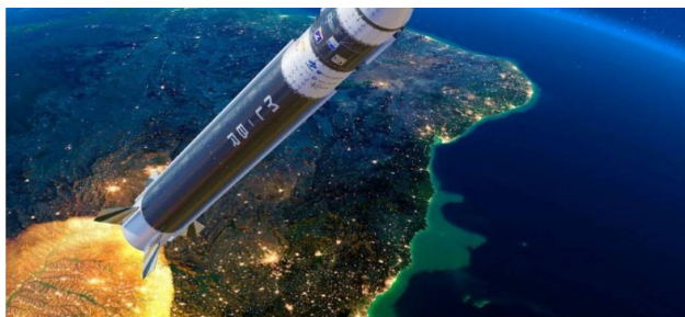
Concepção artística do Microlançador Brasileiro (MLBR), com 12 metros, 3 estágios e capacidade de levar até 40 kg à órbita - MLBR/Divulgação
